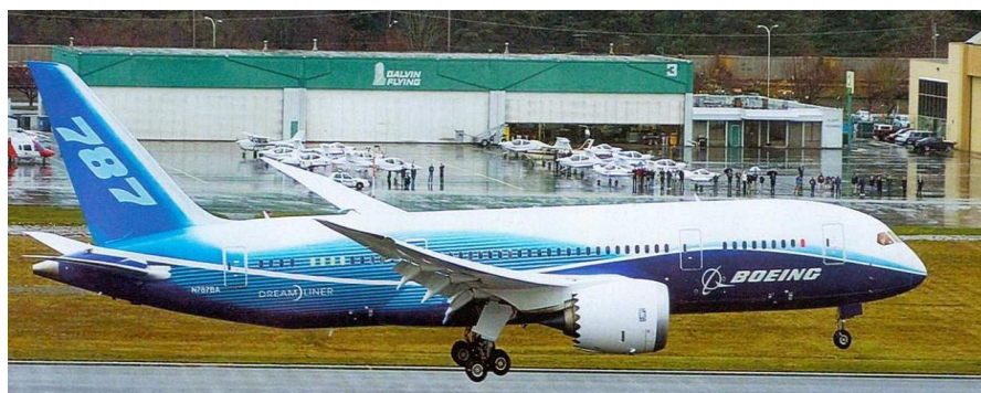
Σχήμα 2.10: Πρώτη απογείωση του 787. Προσέξτε την καμπυλότητα που εμφανίζουν τα φτερά λόγω φόρτισης
