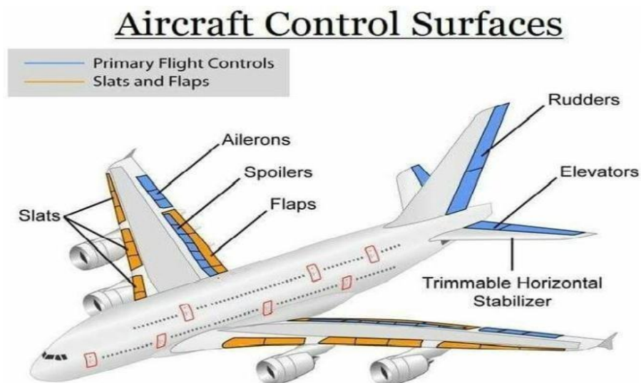
Σχήμα 2.1: Basic control surfaces of Fixed wing Aircraft (Βασικές επιφάνειες ελέγχου των αεροσκαφών σταθερής πτέρυγας)
