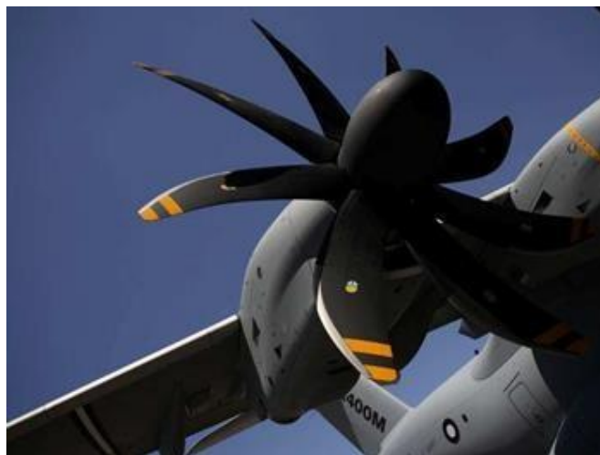
Σχήμα 2.28: Turboprop με προηγμένα αεροδυναμικά έλικα
