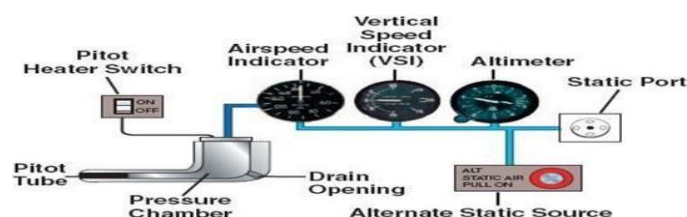
Σχήμα 2.6: Βασική συνδεσμολογία συστήματος Pitot.
