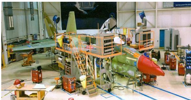
Σχήμα 2.25: Προετοιμασία αεροσκάφους για έλεγχο στεγανότητας
