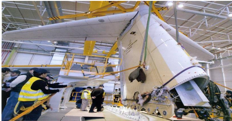
Σχήμα 2.31: Λεπτομέρεια από τη συναρμολόγηση του κάθετου σταθερού τύπου T-tail
