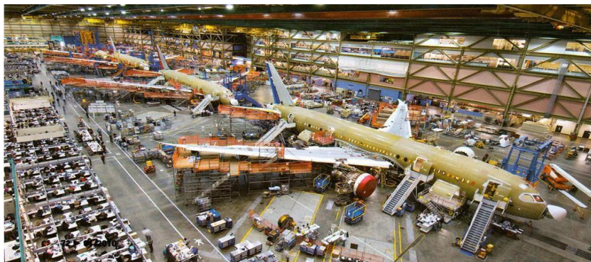
Σχήμα 2.15: Γραμμή τελικής συναρμολόγησης του Boeing 787 στο Έβερετ
