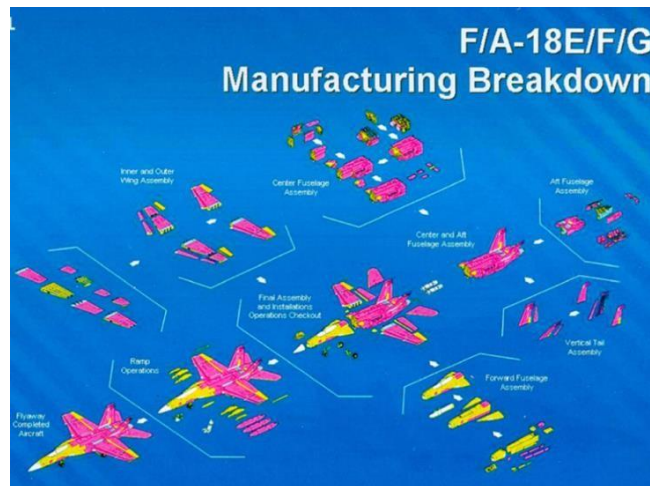
Σχήμα 2.19: Κατασκευαστικά στάδια του F/A-18F
