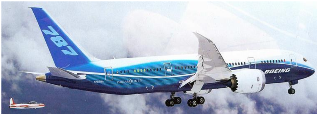
Σχήμα 2.11: Κατά τη διάρκεια των πρώτων δοκιμαστικών πτήσεων το σύστημα προσγείωσης παρέμενε σε θέση έκτασης Προσέξτε ότι η πτήση του παρακολουθείται από ένα βοηθητικό αεροσκάφος T-33
