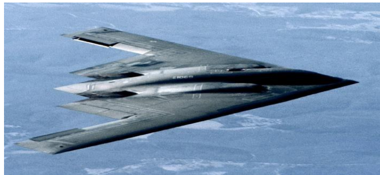
Σχήμα 2.9: Το Αμερικανικό B-2 Spirit είναι στρατηγικό βομβαρδιστικό. Διαθέτει διάταξη ιπτάμενης πτέρυγας και μπορεί να ανταπεξέλθει σε διηπειρωτικές αποστολές.
