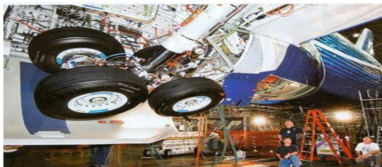
Σχήμα 2.16: Στατικές δοκιμές του δεξιού κύριος σκάλους προσγείωσης.
