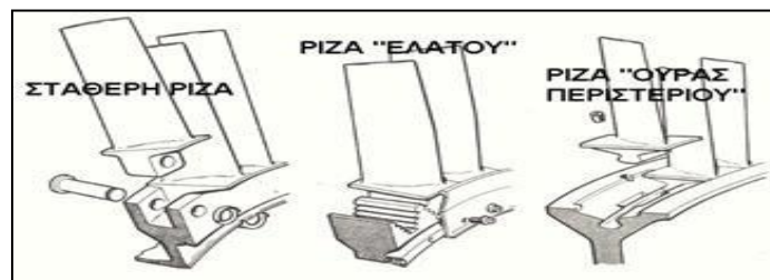
Σχήμα 3.37: Τρόποι συναρμογής κινητών πτερυγίων συμπιεστή στο τύμπανο ή τους δίσκους
