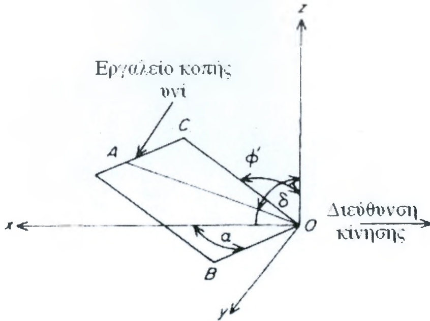
Εικ.3.3. Τρισδιάστατη αναπαράσταση ενός επίπεδου κεκλιμένου εργαλείου οργώματος.
