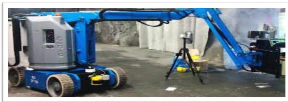
Εικόνα2.21 ρομποτικό σύστημα ελέγχου καταγράφει πιθανή ρωγή η παραμόρφωση
