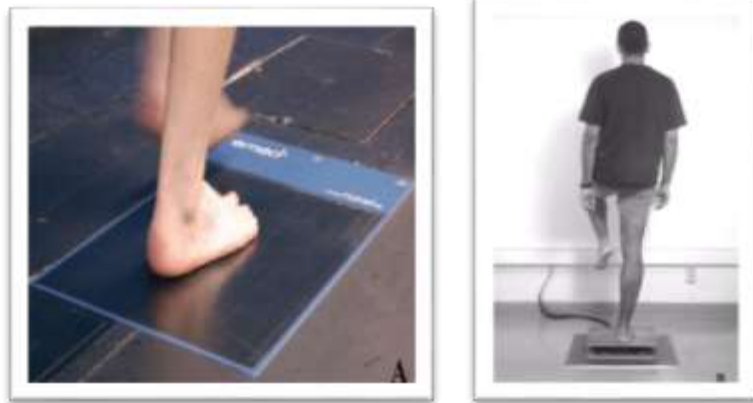
« Εικόνα 4.7. (Α) Πλατφόρμα πίεσης, Β) Μονοποδική στήριξη σε δυναμοδάπεδο. Τροποποιημένα από https://www.researchgate.net »
