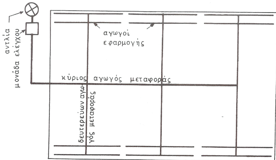
Διάταξη δικτύου όταν η πηγή του νερού είναι στο άκρο της αρδευόμενης εκτάσεως
