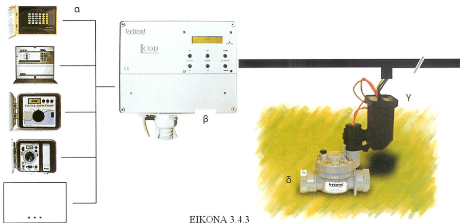
Δίκτυο κεντρικού ελέγχου άρδευσης με καλώδιο 2 αγωγών. (α) προγραμματιστής, (β) κωδικοποιητής, (γ) πηγίο με αποκωδικοποιητή, (δ) ηλεκτροβαλβίδα (Πηγή: Irritrol)
