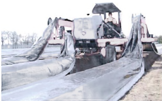
Εικ. 17. Ταυτόχρονο ξεσκέπασμα και κάλυψη φυτείας σπαραγγιού με χρήση καλυπτικού μηχανήματος
