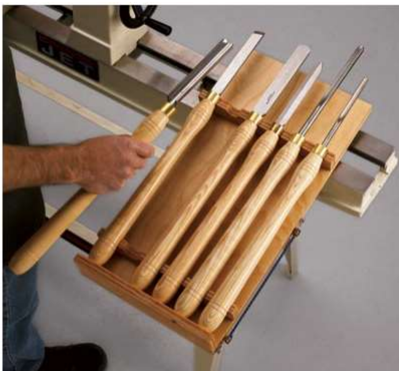
Σχήμα 1.15: Κοπτικά εργαλεία - σκαρπέλα ξυλότορνου. (Πηγή: http://pluton22.blogspot.com/2012/12/blog-post_19.html )
