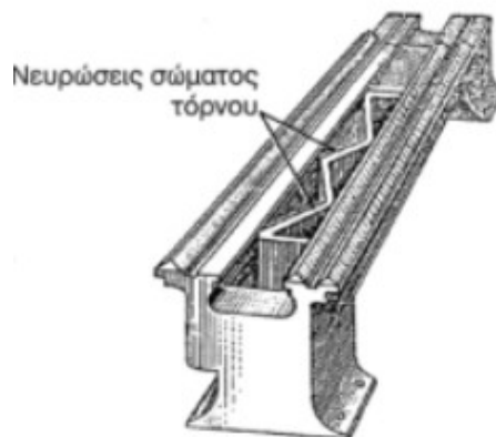
Σχήμα 1.2: Τυπική μορφή κρεβατιού τόννου με νευρώσεις. (Πηγή: Λαζαρίδης, 1990)
