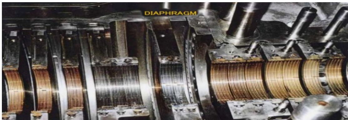
Εικόνα 4: Απεικόνιση κάτω ημικελύφους και σταθερών πτερυγίων ατμοστροβίλου υψηλής πίεσεως
