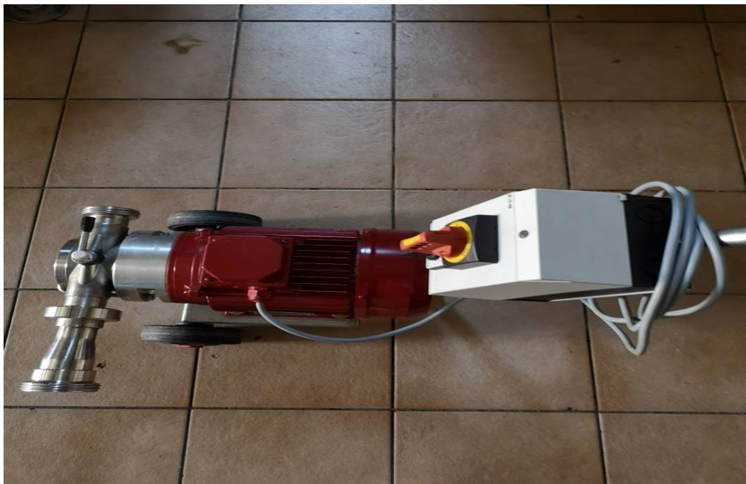
Εικόνα 3-14: Αντλία μεταφοράς Cima
