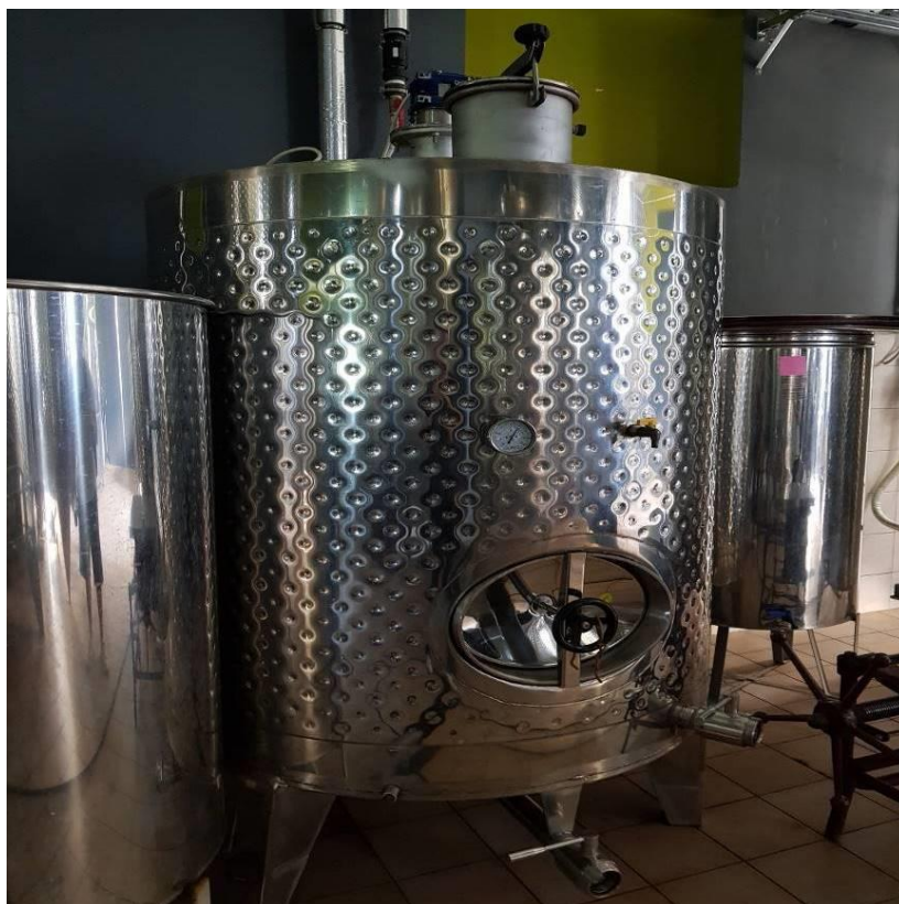
Εικόνα 3-10: Δεξαμενή αποθήκευσης και ανάδευσης κρασιού 2tn
