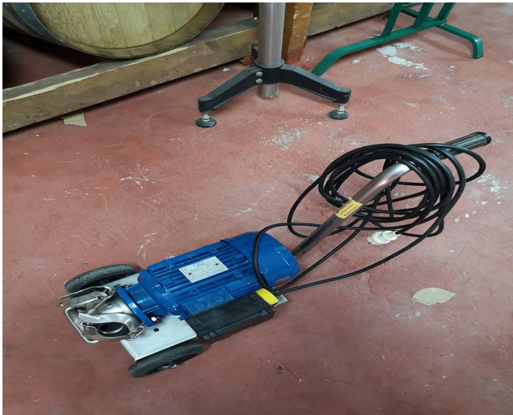
Εικόνα 3-13: Αντλία μεταφοράς Ceg
