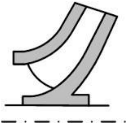
Εικόνα 2.3. Ημιτομή στροφείου αντλίας μικτής ή διαγώνιας ροής 38
