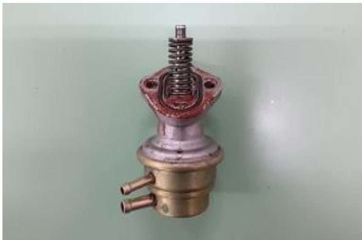
Εικόνα 2.19.: Αντλία με διάφραγμα, αρχή λειτουργίας 55 αντλίας βενζίνης αυτοκινήτου
