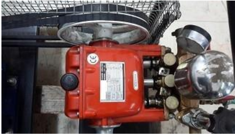
Εικόνα 2.20.: Πολυκύλινδρη αντλία θετικής εκτόπισης
