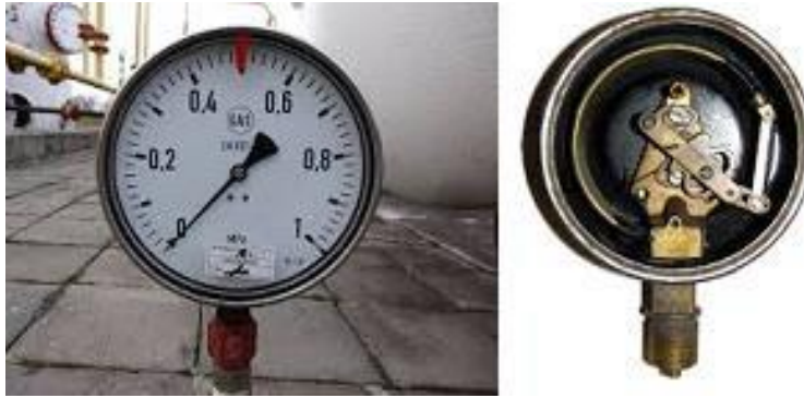
Εικόνα 1.5.:Μηχανικά μανόμετρα μέτρησης της σχετικής πίεσης 10
