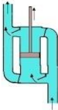
Εικόνα 2.21.: Αντλία διπλής ενέργειας 57
