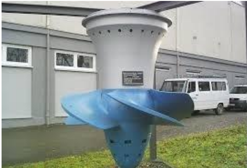
Εικόνα 2.34.: Υδροστρόβιλος Karlan (αξονική ροή) 64
