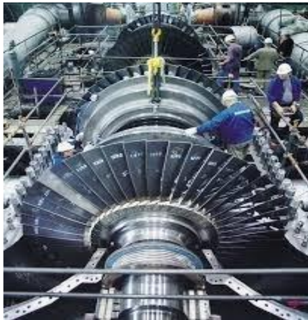
Εικόνα 2.36.: Πολυβάθμιοι ατμοστρόβιλοι αξονικής και ακτινικής ροής 66
