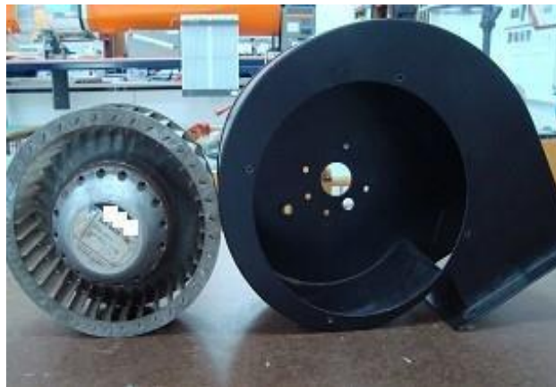
Εικόνα 2.25.: Φυγοκεντρικός ανεμιστήρας – Φυγοκεντρική πτερωτή κλειστού τύπου
