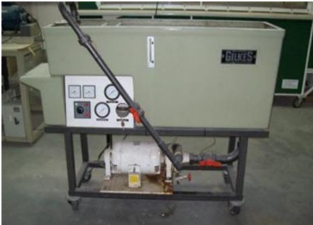
Εικόνα 4.5: Εργαστηριακή Συσκευή Φυγοκεντρικής Υδραντλίας
