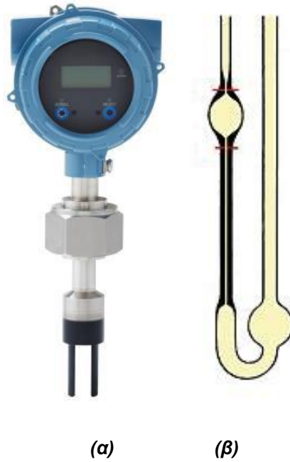
Εικόνα 1.2.: (α)Γυάλινο ιξωδόμετρο τύπου U 7 β)Ηλεκτρονικό περιστροφικό ιξωδόμετρο 8
