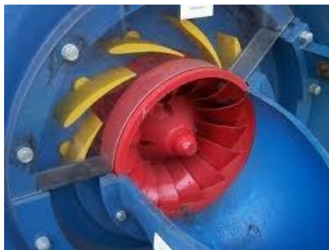
Εικόνα 2.40.: Francis (ακίνητη και κινητή πτερωτή) ακτινικής ροής 71
