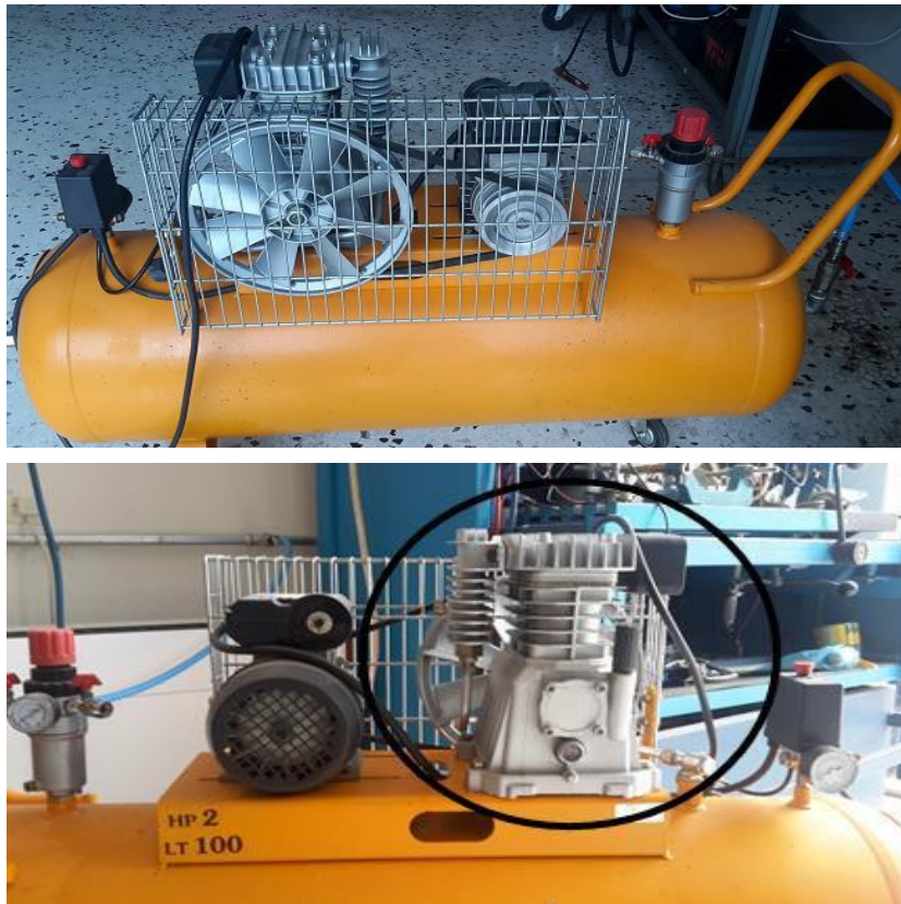
Εικόνα 2.29 και 2.30..: Οι δύο όψεις ενός εμβολοφόρου, αερόφυκτου, παλινδρομικού αεροσυμπιεστή και η λειτουργία του.
