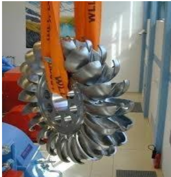
Εικόνα 2.39.: Υδροστρόβιλοι Pelton (μερικής επαπτομενικής προσβολής) 70
