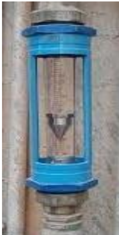
Εικόνα 1.11. :Ροόμετρο με πλωτήρα 13 ,
