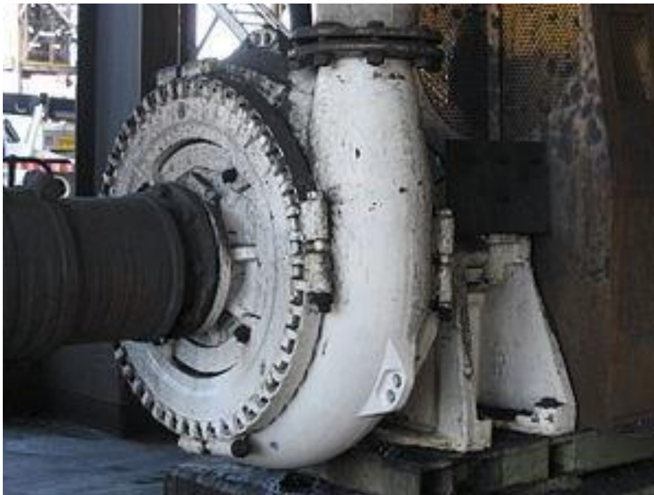
Εικόνα 2.1.: Φυγοκεντρική αντλία με σπειροειδές κέλυφος 36
