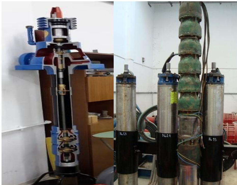
Εικόνα 2.14.:Κατακόρυφες φυγοκεντρικές αντλίες
