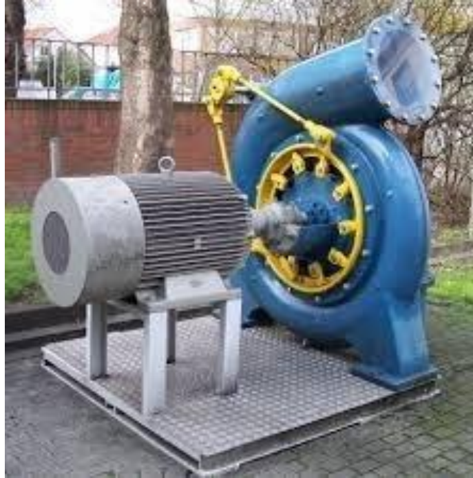
Εικόνα 2.33.: Υδροστρόβιλος Francis, περίβλημα – κέλυφος, ρύθμιση σταθερών πτερυγίων και γεννήτρια 63
