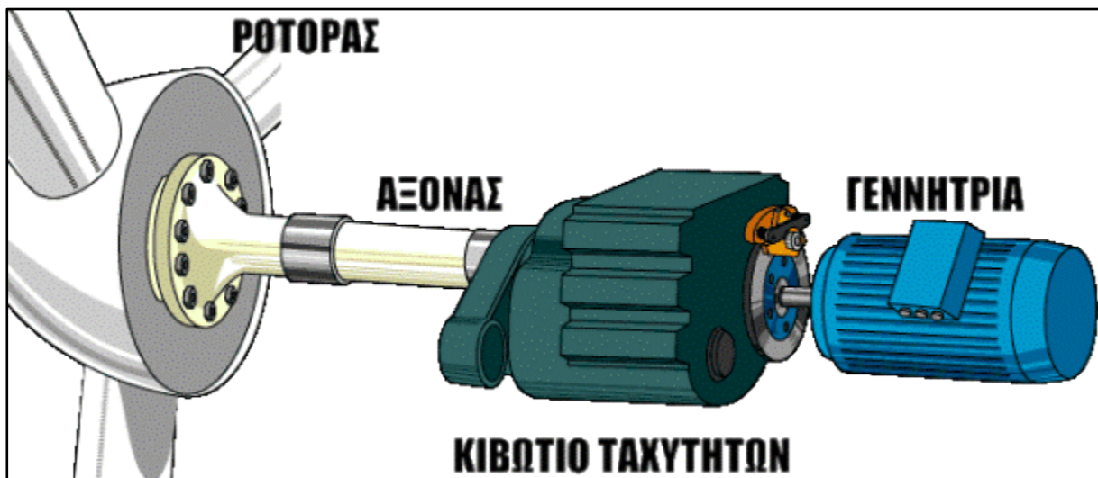
Εικόνα 13. Ηλεκτρογεννήτρια ανεμογεννήτριας.
