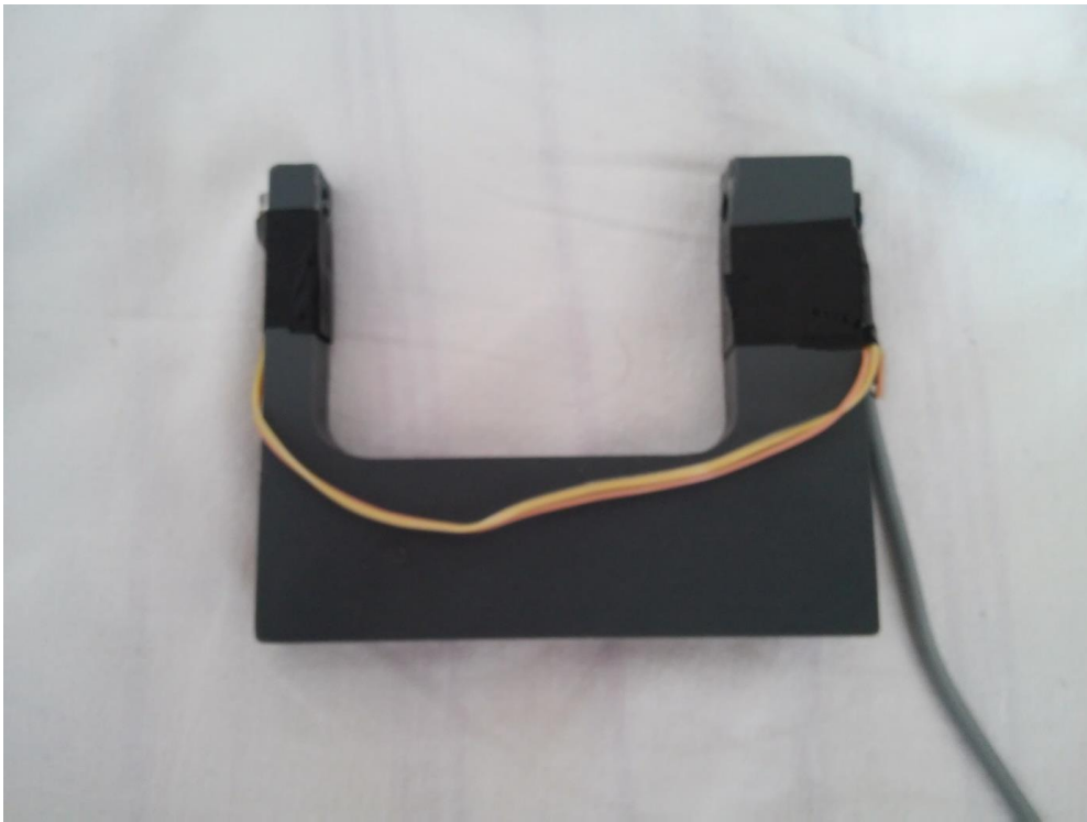
Σχήμα 2.11 Πλάγια όψη φωτοπύλης
