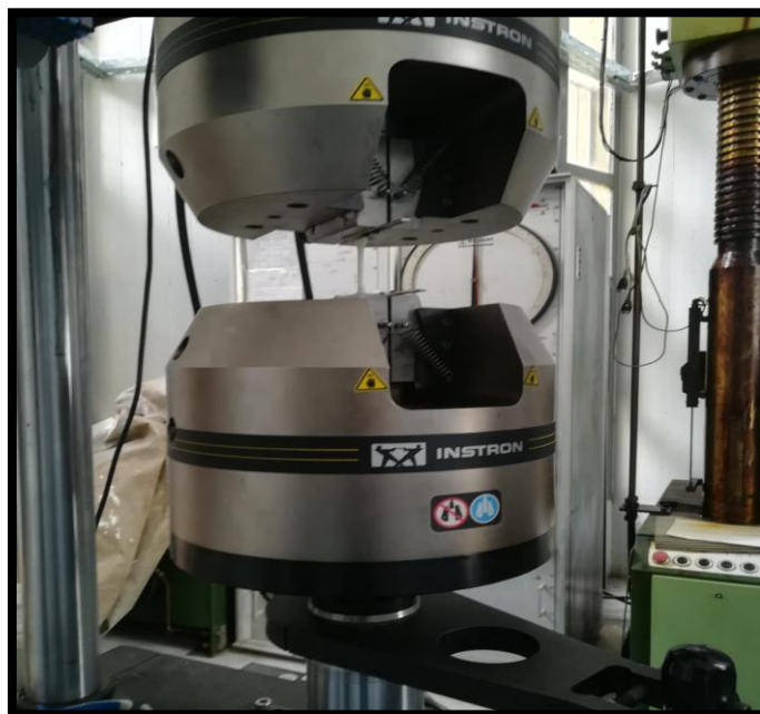
Εικόνα 5.2 Συγκράτηση δοκιμίου πριν την πειραματική διαδικασία
