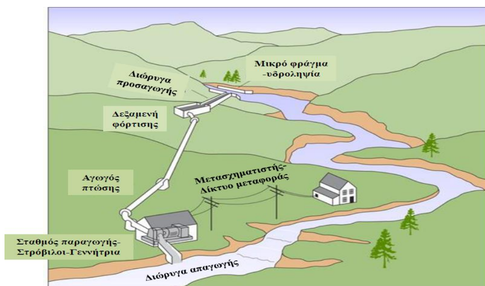
Εικόνα 4.1: Συνιστώσες ενός τυπικού ΜΥΗΕ.
