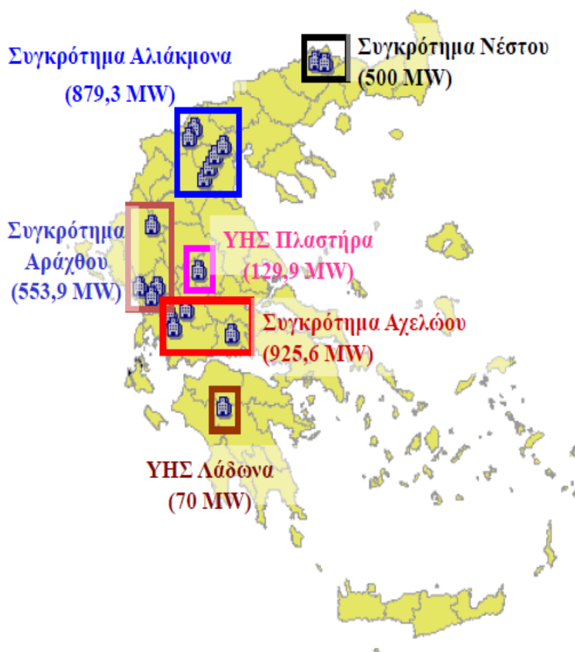
Εικόνα 3.30: Μεγάλα υδροηλεκτρικά έργα της ΔΕΗ.
