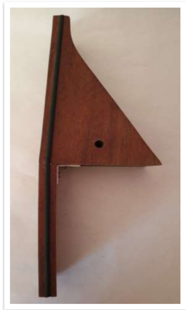
Εικόνα 4.11: Μοντέλο φράγματος παρουσία διαφραγματικού τοίχου.
