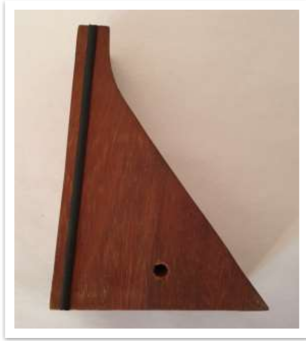
Εικόνα 4.10: Μοντέλο φράγματος χωρίς διαφραγματικό τοίχο.
