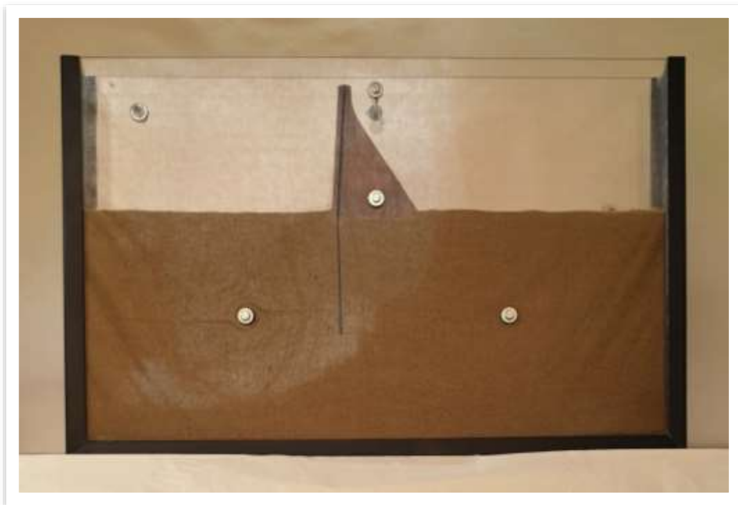
Εικόνα 6.1: Ολοκληρωμένη πειραματική διάταξη με φράγμα παρουσία διαφραγματικού τοίχου σε συνθήκες άδειου ταμιευτήρα.
