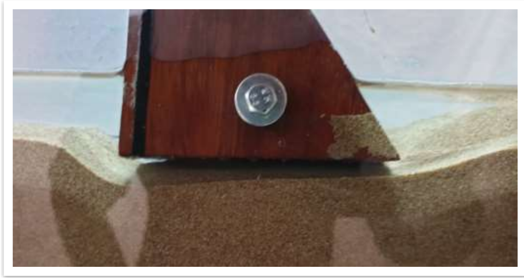
Εικόνα 6.5: Αστοχία θεμελίωσης φράγματος λόγω υποσκαφής.
