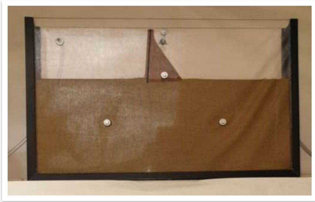
Εικόνα 6.3: Ολοκληρωμένη πειραματική διάταξη με φράγμα χωρίς διαφραγματικού τοίχου σε συνθήκες άδειου ταμιευτήρα.
