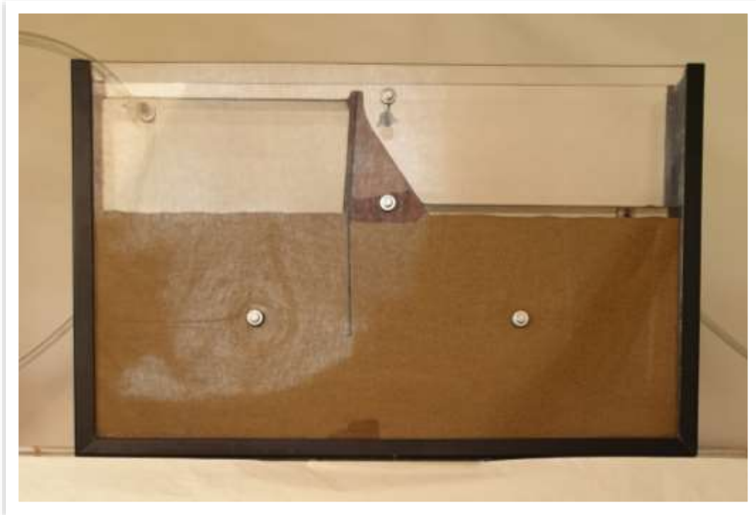
Εικόνα 6.2: Ολοκληρωμένη πειραματική διάταξη με φράγμα παρουσία διαφραγματικού τοίχου σε συνθήκες γεμάτου ταμιευτήρα.
