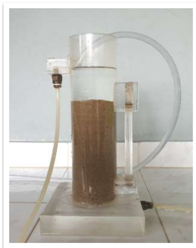
Εικόνα 5.3: Μέτρηση διαπερατότητας με διαπερατόμετρο σταθερού υδραυλικού φορτίου.
