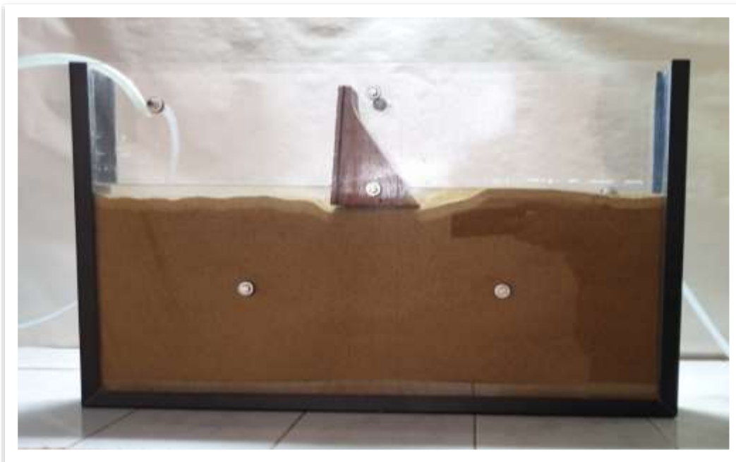
Εικόνα 6.4: Απόπειρα πλήρωσης του ταμιευτήρα με νερό στην περίπτωση φράγματος χωρίς διαφραγματικό τοίχο.
