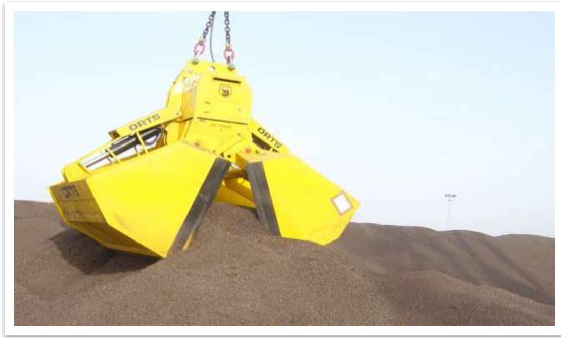
Εικόνα 3.15: Αρπάγη εκσκαφής σε συρματόσχοινα. (Διαδίκτυο)
