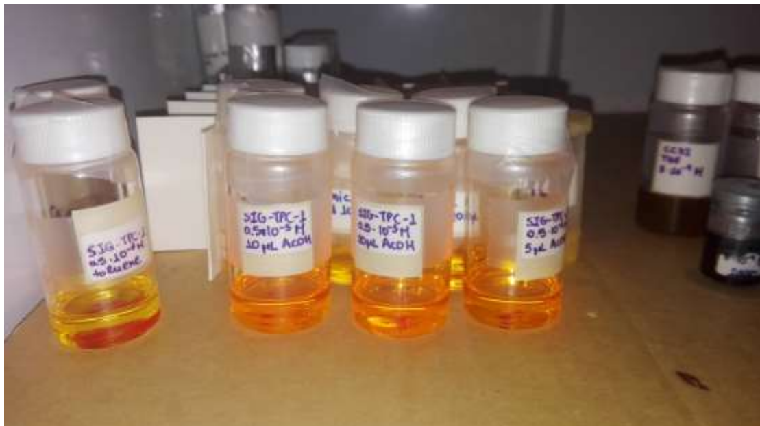
Εικ. 4.9: Μερικά από τα δείγματα των οργανικών χρωστικών που χρησιμοποιήθηκαν για την πραγματοποίηση των πειραμάτων. Οι χρωστική που χρησιμοποιήσαμε είναι η SIG -TPC-1, όπου από την μορφή σκόνης φτιάξαμε τα παραπάνω διαλύματα.
