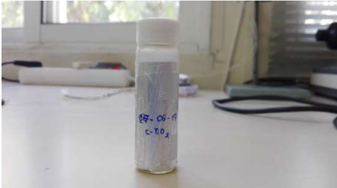
Εικ. 4.5: Η συμπαγής τιτάνια έχει σχεδόν κίτρινο χρώμα, είναι φωτοευαίσθητη και έτσι καλύπτεται το δοχείο εξωτερικά με αλουμινόχαρτο για να περιορίσουμε τις ακτίνες φωτός να την επηρεάζουν
