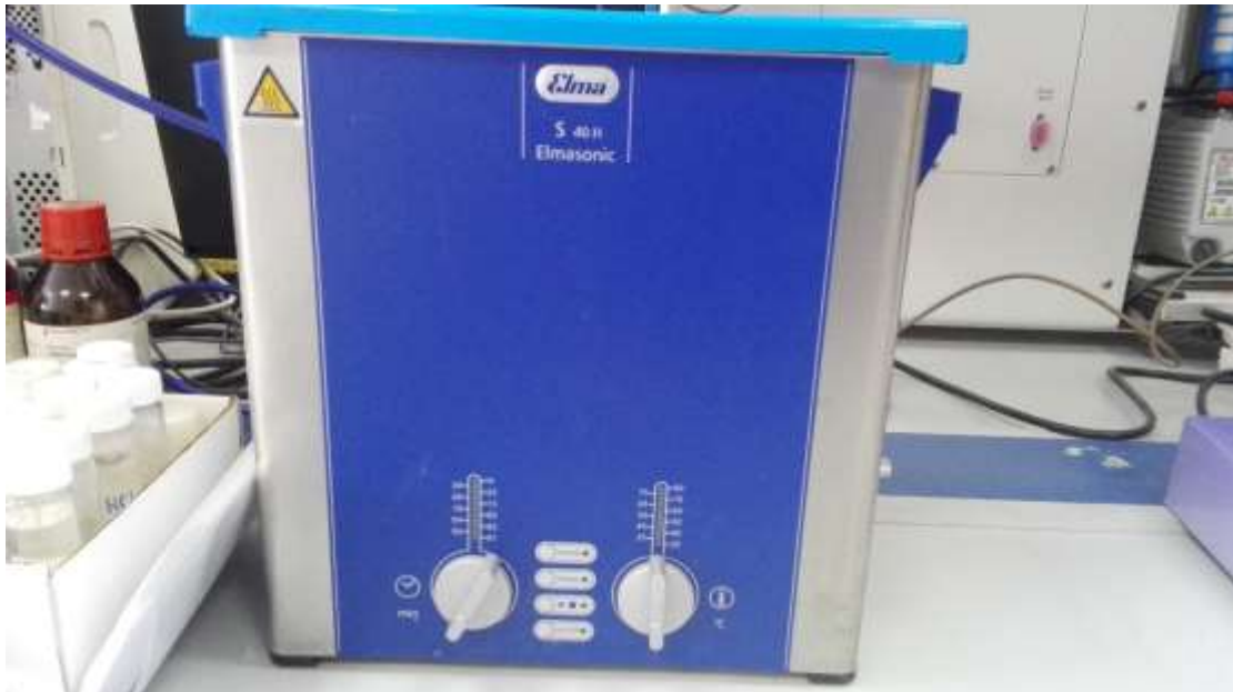
Εικ. 4.8: Παραπάνω απεικονίζεται το λουτρό υπερήχων που χρησιμοποιήθηκε στα πειράματα, βλέπουμε τις επιλογές χρόνου που έχουμε και θερμοκρασίας, με την πίεση του πλήκτρου start ξεκινά η διαδικασία.
