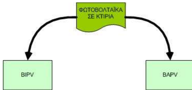
Εικ. 3.5: Οι 2 κατηγορίες των φωτοβολταϊκών συλλεκτών που τοποθετούνται σε κτήρια βιομηχανίες κλπ.
