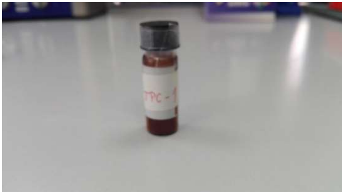
Εικ. 4.7: Οι χρωστικές που χρησιμοποιήσαμε στα πειράματα είναι σε σκόνη, φαίνονται στο δοχείο τους κλεισμένες πολύ καλά με παραφίλμ για την αποφυγή μόλυνσής τους, επίσης τις τοποθετούμε σε χώρο κλειστό μακριά από οποιοδήποτε φωτισμό.
