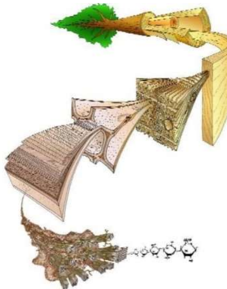
Εικόνα 1.5: Εδώ βλέπουμε από τι αποτελείται ένα φυσικό σύνθετο, το ξύλο. 5
