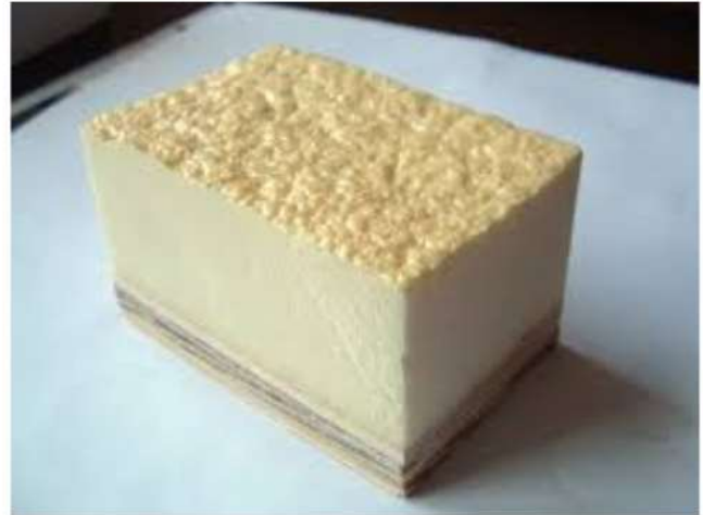
Εικόνα 5.2: Αφρός πολυουρεθάνης όπως υπάρχει στο εμπόριο (α), και σε στερεή μορφή (β)
