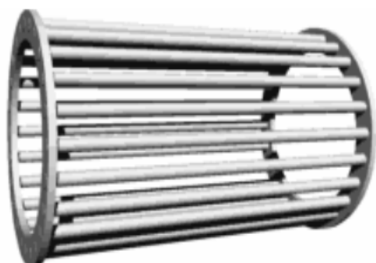
Εικόνα 2.21: Δρομέας γεννήτριας βραχυκυκλωμένου κλωβού.
