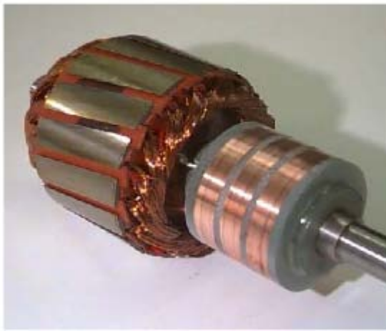
Εικόνα 2.24: Δρομέας και στάτης μηχανής δακτυλιοφόρου δρομέα.
