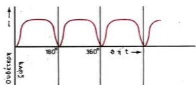
Εικόνα 2.6: Μεταβολή της έντασης του ανορθωμένου ρεύματος όταν διαρρέει φορτίο R .
