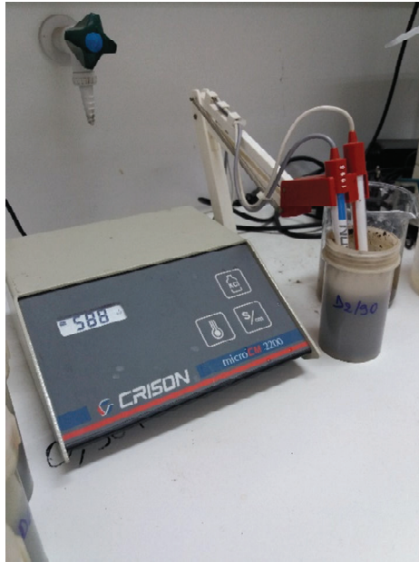
Εικόνα 24: Μέτρηση αγωγιμότητας με αγωγιμόμετρο.
