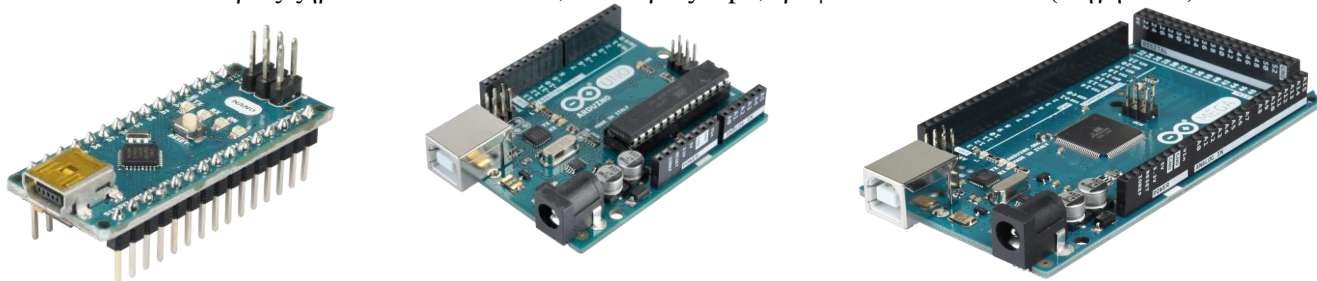
Εικόνα 1.15: Μονάδα επεξεργασίας (εγκέφαλος) Arduino Nano, Uno, Mega αντίστοιχα (Πηγή E-15)
