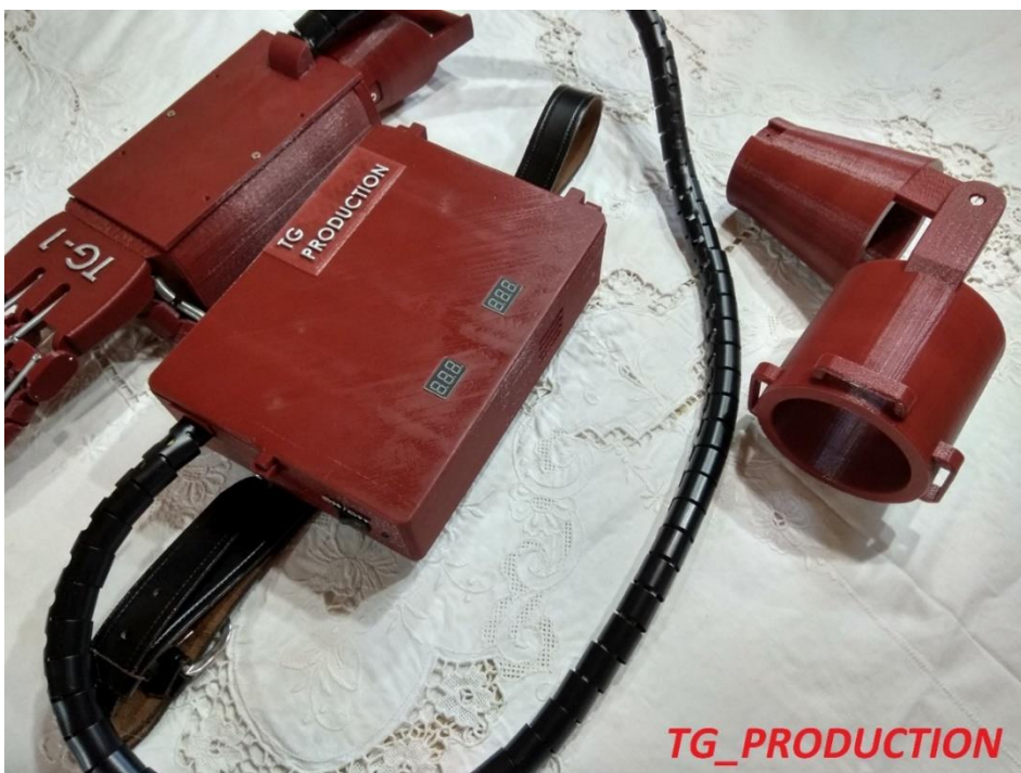
Εικόνα 6.67:Συναρμολογημένη κατασκευή και ενδεικτική όρθωση
