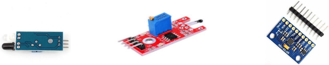
Εικόνα 1.17: Αισθητήρας υπέρυθρων, αισθητήρας θερμοκρασίας, γυροσκόπιο (Πηγή E-21)
