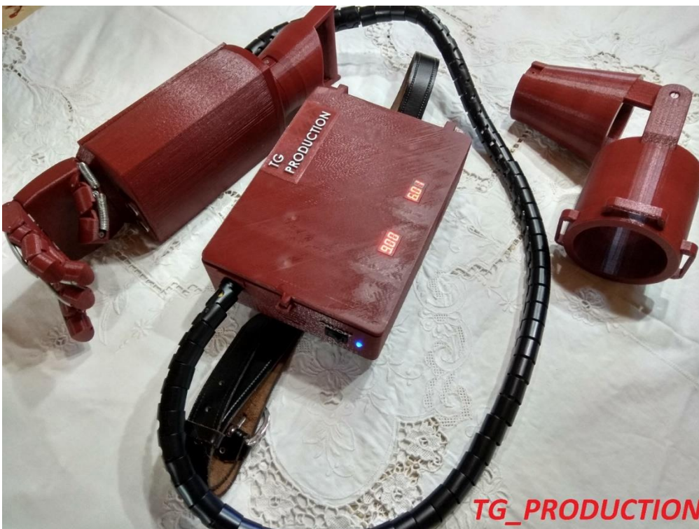
Εικόνα 6.68:Κατασκευή εν ώρα λειτουργίας με το ηλεκτρολογικό κύκλωμα
