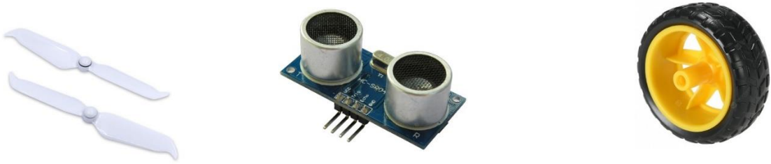
Εικόνα 1.16: Έλικες, αισθητήρας υπερήχων, ρόδες (Πηγή E-16)
