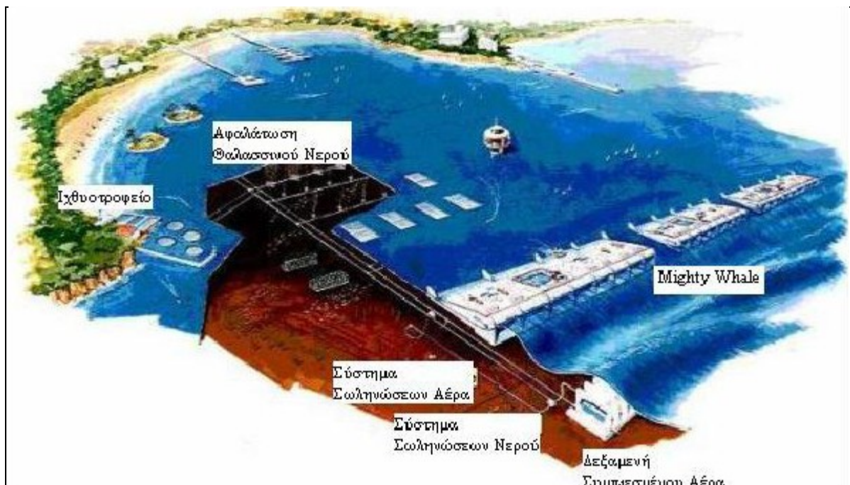
Εικόνα 72: Προτεινόμενη εφαρμογή παράταξης συσκευών MW.
