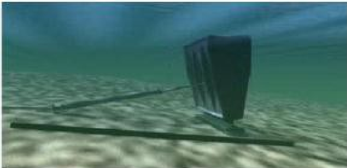
Εικόνα 83: Μονάδα WaveRoller τοποθετημένο στον πυθμένα.
