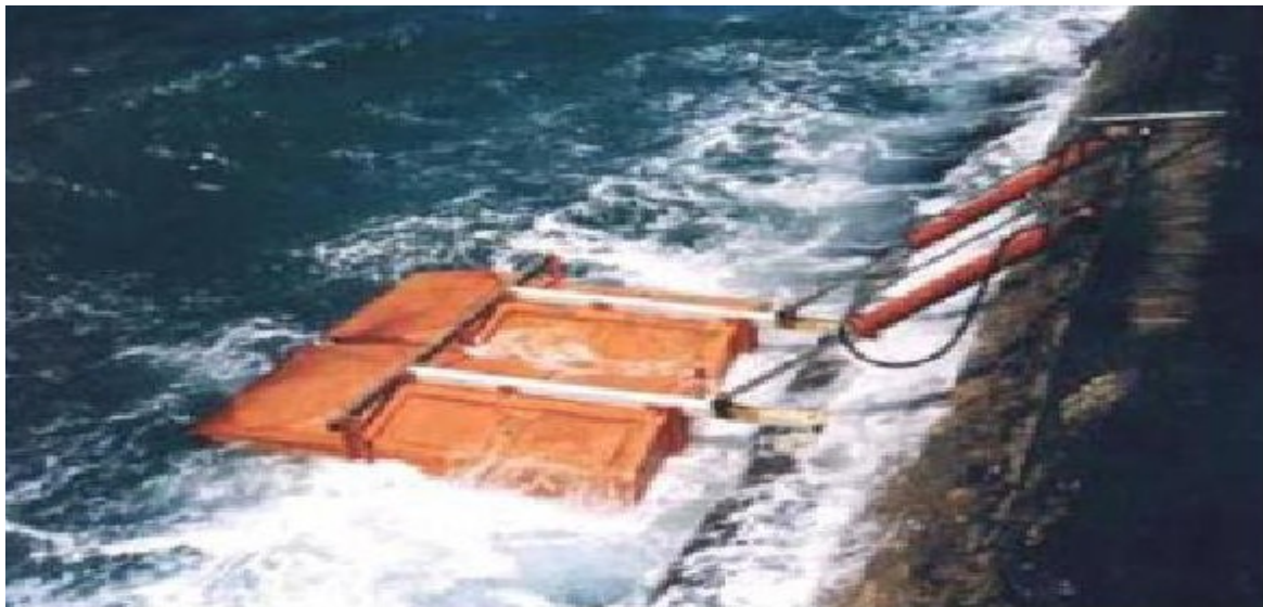
Εικόνα 68: Εγκατάσταση συστήματος SDE στο Ισραήλ.
