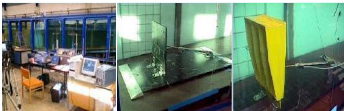
Εικόνα 86: Δοκιμές σε δεξαμενή και δοκιμές μετρήσεων Doppler (LabofWaterResHelsinkiUniversityofTechnology).
