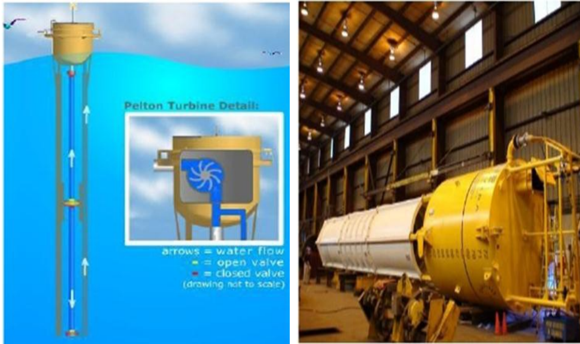
Εικόνα 98: Η λειτουργία του AquaBuoy και η προετοιμασία καθελκυσμού.
