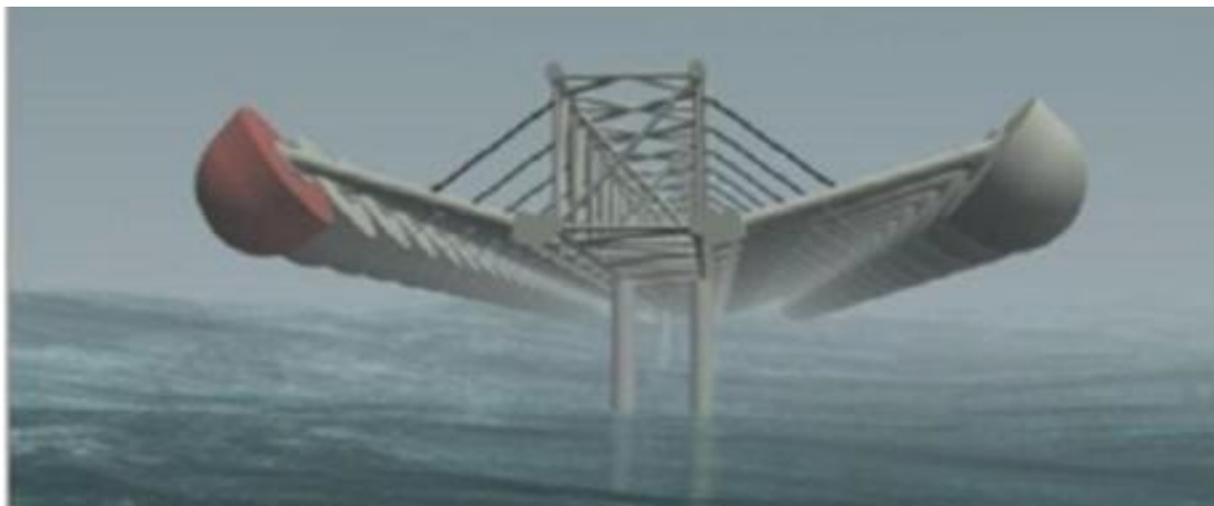
Εικόνα 93: Σύστημα WaveStar σε θέση ασφαλείας.
