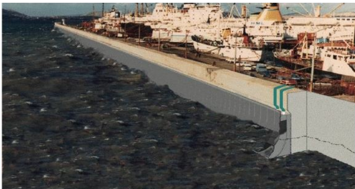
Εικόνα 58: Προτεινόμενη εφαρμογή μετατροπής κυματικής ενέργειας σε κυματοθραύστη WECA.
