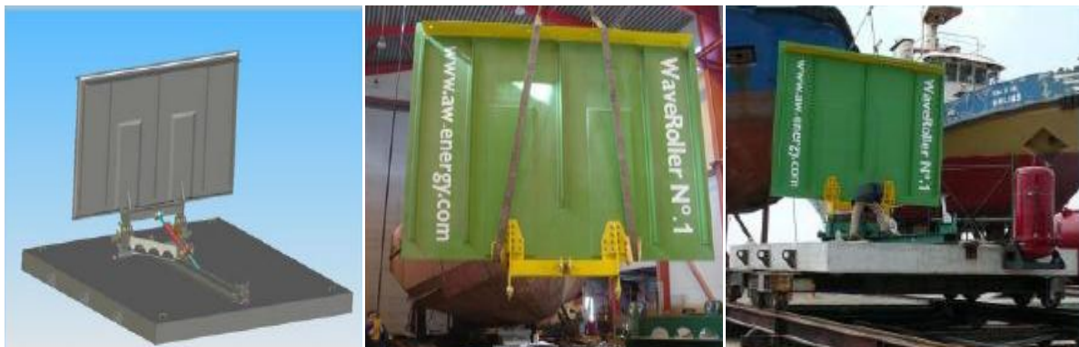
Εικόνα 89: Σχεδιασμός και κατασκευή διάταξης WaveRoller (2006).
