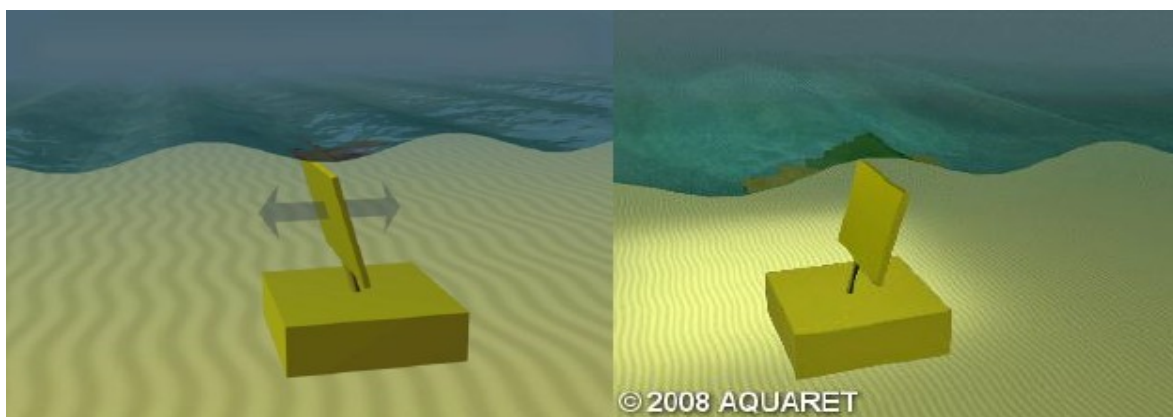
Εικόνα 34: Παλλόμενος συλλέκτης κυματικών κλυδωνισμών.
