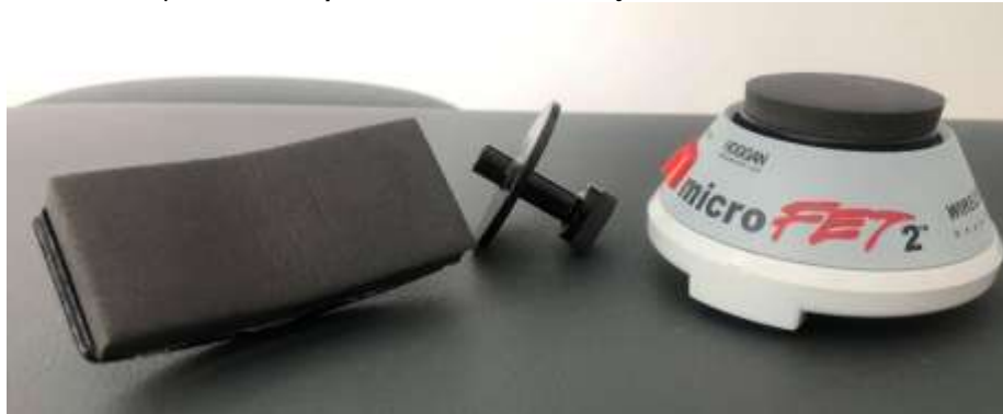
Εικόνα 3.5 Δυναμόμετρο χειρός MicroFET 2
