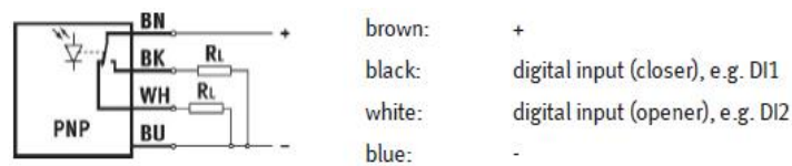
Εικόνα 4.3.4.3 Κύκλωμα και συνδεσμολογία οπτικό-ηλεκτρονικού αισθητήρα [28].
