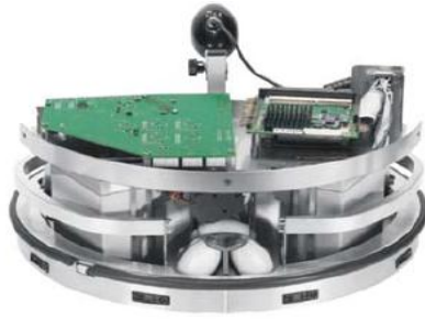
Εικόνα 2.2.14.1 Μονάδα ελέγχου του Robotino, αποτελούμενη από τον ενσωματωμένο υπολογιστή (αριστερή πλευρά) και τον μικροελεγκτή (δεξιά πλευρά) [29].
