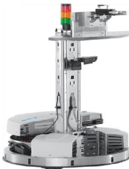
Εικόνα 2.1.1 Το ρομποτικό αυτοκινούμενο σύστημα Robotino έκδοσης premium της εταιρείας Festo.
