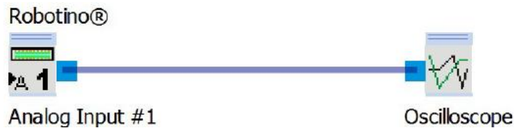
Εικόνα 5.3.1.1 Σύνδεση A/1 (που αντιστοιχεί στον επαγωγικό αισθητήρα) με παλμογράφο.
