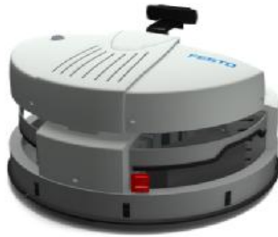
Εικόνα 4.1.1 Με το κόκκινο χρώμα απεικονίζεται η κατάλληλη υποδοχή του τροφοδοτικού, στο πίσω μέρος της πλατφόρμας [28].
