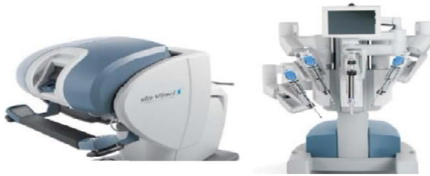
Εικόνα 1.1.8 Το χειρουργικό σύστημα da Vinci αποτελούμενη από την κονσόλα του χειρουργού (αριστερά) και τον ρομποτικό πύργο (δεξιά).
