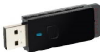
Εικόνα 2.2.18.1 WLAN - USB adapter, μοντέλου N150 της εταιρείας NETGEAR.
