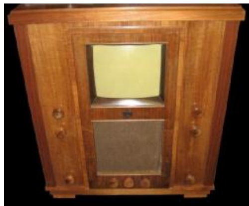
Εικόνα 1.15. Τηλεόραση Telefunken FE-III CRT 30cm Germany (1934-1935)
