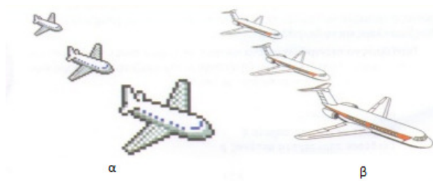
Εικόνα 14. α. 2-D εικόνα bitmap, β. 2-D εικόνα vector
