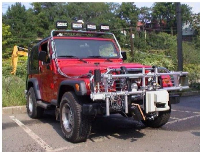
Εικόνα 13. Αυτόνομο σύστημα πλοήγησης του Πανεπιστημίου CarnegieMellon
