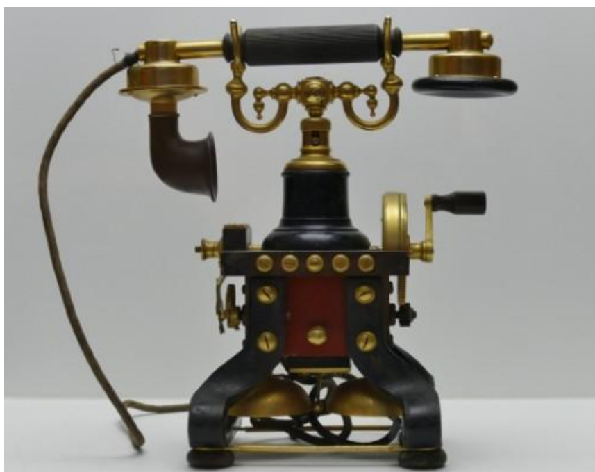
Εικόνα 1.10...:Χειροκίνητη επιτραπέζια πολυτελής τηλεφωνική συσκευή σουηδικής κατασκευής μοντέλο Σκέλετον, γνωστή ως ραπτομηχανή, πατέντα του 1882. Έτος κατασκευής 1892. Πηγή: https://www.mixanitouxronou.gr/i-istoria-tou-tilefonou-ke-tis-epikinonias-apo-tis-archees-friktores-pou-metedosan-tin-alosi-tis-trias-sta-perifima-kokkina-tilefona-ton-80s-ke-stin-kiniti-tilefonia-to-mousio-tou-ote-sigkini-k/
