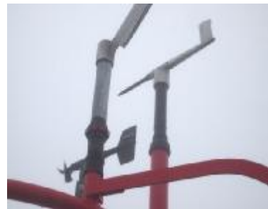
Εικόνα 1.10: Ανεμόμετρο με σωλήνα Pitot
