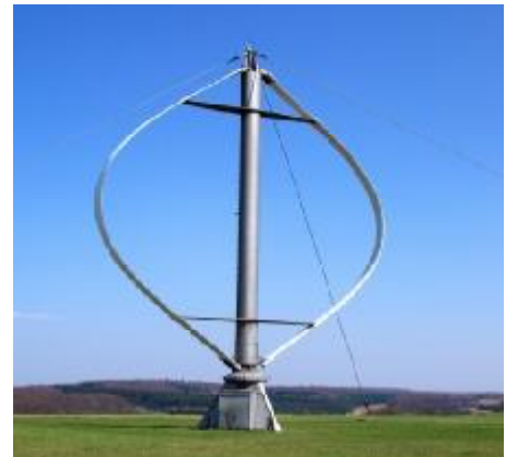
Εικόνα 1.3 : Ανεμογεννήτρια Darrieus, κάθετου άξονα
