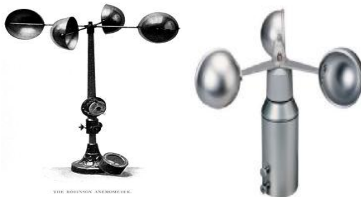
Εικόνα 1.6 : Κυπελλοφόρα ανεμόμετρα τριών και τεσσάρων κυπέλλων
