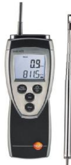
Εικόνα 1.8 : Ανεμόμετρο θερμού σύρματος
