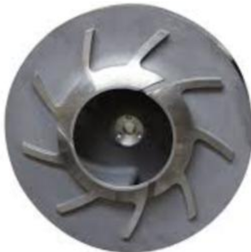
Εικόνα 11: Οι αντλίες με ανοικτά τα στροφεία είναι απλές στην κατασκευή, έχουν μεγάλα κενά μεταξύ των πτερυγίων και αφήνουν να περάσουν χωρίς ιδιαίτερα προβλήματα ξένες φερτές ύλες που περιέχονται από ακάθαρτα νερά. Πηγή: www.lm-pumpen.de .
