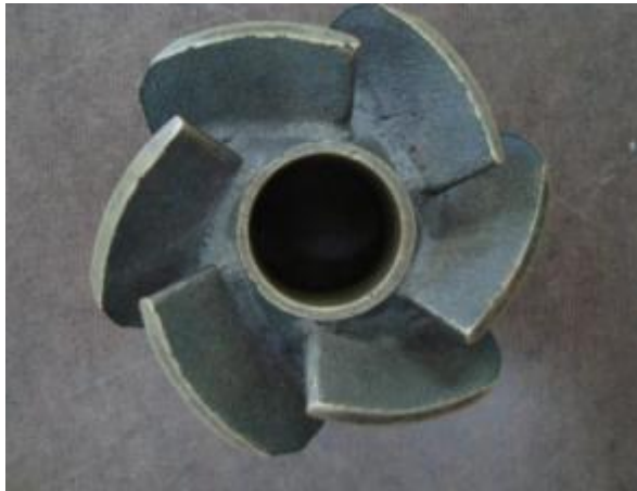
Εικόνα 10: Το στροφείο του ημίκλειστου τύπου αποτελείται από ένα δίσκο. Τα πτερύγια είναι τοποθετημένα στη μία πλευρά του δίσκου και από το μέρος της αναρρόφησης του νερού.
