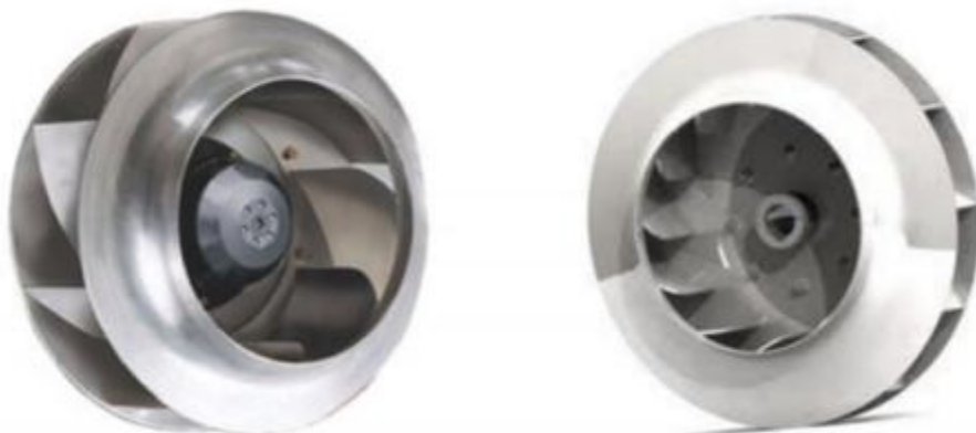
Εικόνα 9: Οι αντλίες με κλειστά στροφεία αποτελούνται από δύο δίσκους και τα πτερύγια βρίσκονται ανάμεσα τους. Ο ένας δίσκος έχει στο κέντρο μία οπή για την είσοδο του νερού κατά την αναρρόφηση στα πτερύγια. Πηγή: www.lm-rumpen.de .
