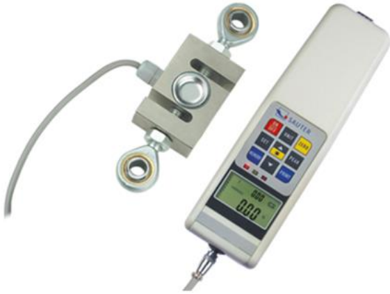
Εικόνα 7: Δυναμοκυψέλη τύπου-Σκαι συσκευή καταγραφής που χρησιμοποιήθηκαν στην μελέτη για τη μέτρηση της μέγιστης δύναμης
