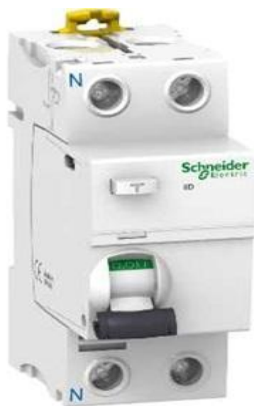
Εικόνα 7: Δ.Δ.Ρ. 63A διπολικός με I_{\Delta N}=30\text{mA} , τύπου A
