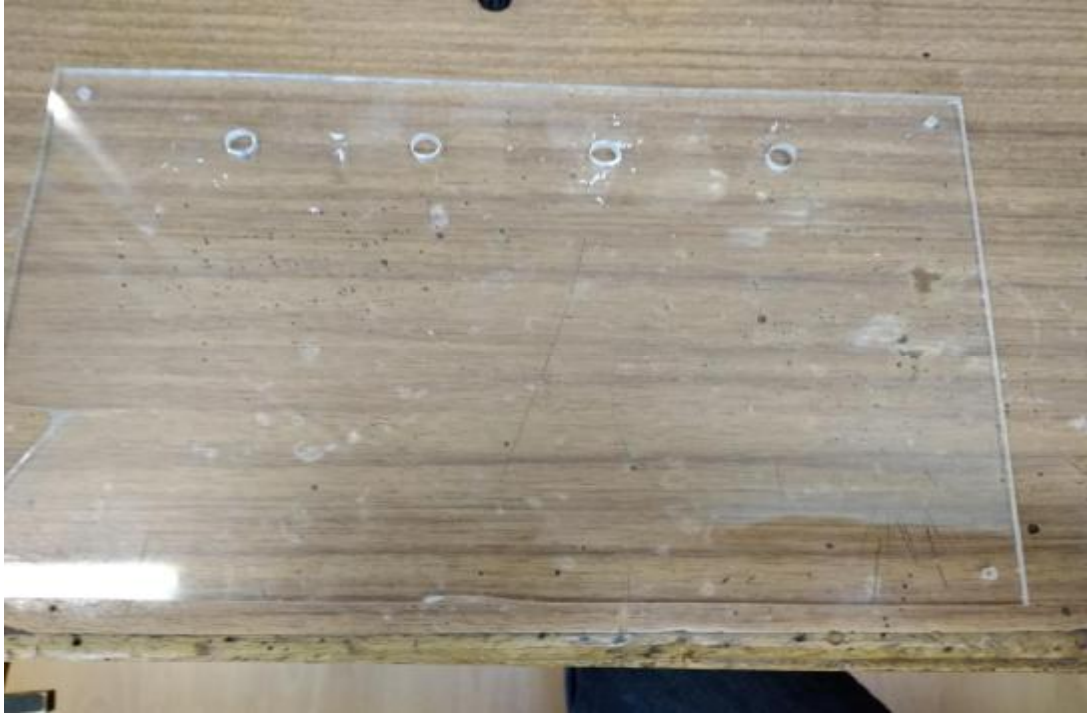
Εικόνα 40: Άνοιγμα οπών στο plexiglass
