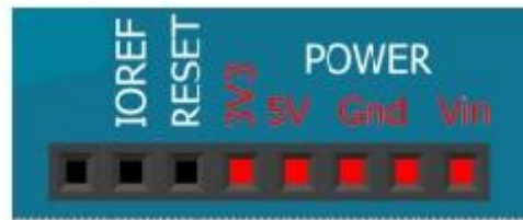
Εικόνα 19: Pins τάσης εισόδου, γείωσης και τάσης παραγωγής
