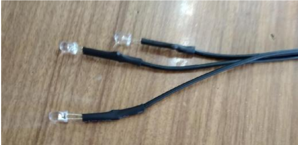
Εικόνα 35: Σύνδεση led μέσω εύκαμπτων καλωδίων
