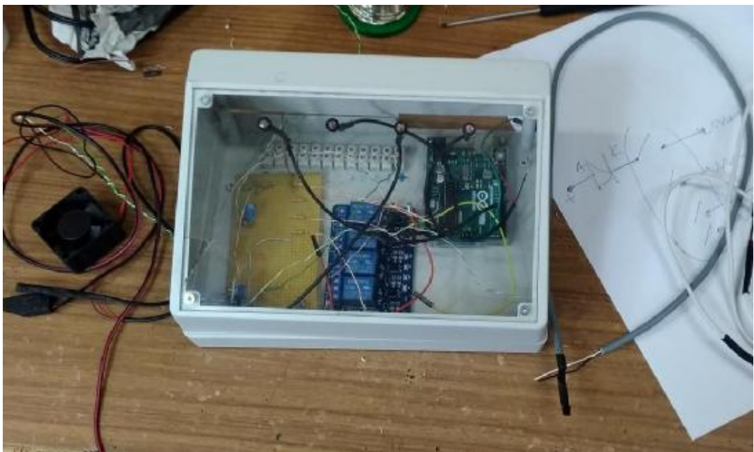
Εικόνα 41: Τοποθέτηση του συστήματος μέσα στο κουτί
