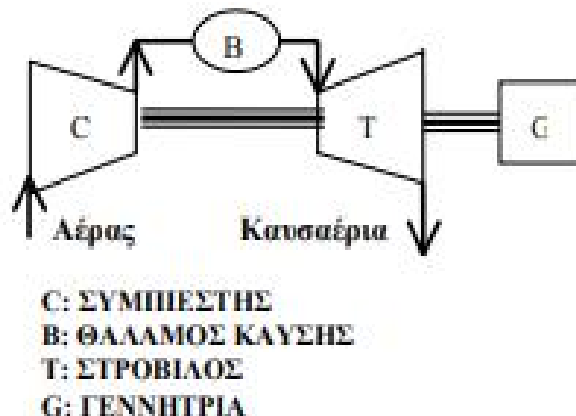
Σχήμα 1: Αεροστρόβιλος Ανοικτού Κυκλώματος μονού άξονα [Πηγή: Ντελκής, 2015]
