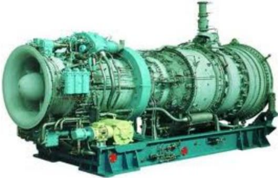
Εικόνα 2:Εγκατάσταση Ναυτικού Αεριοστρόβιλου [Πηγή: Πυργιώτης, 2014]
