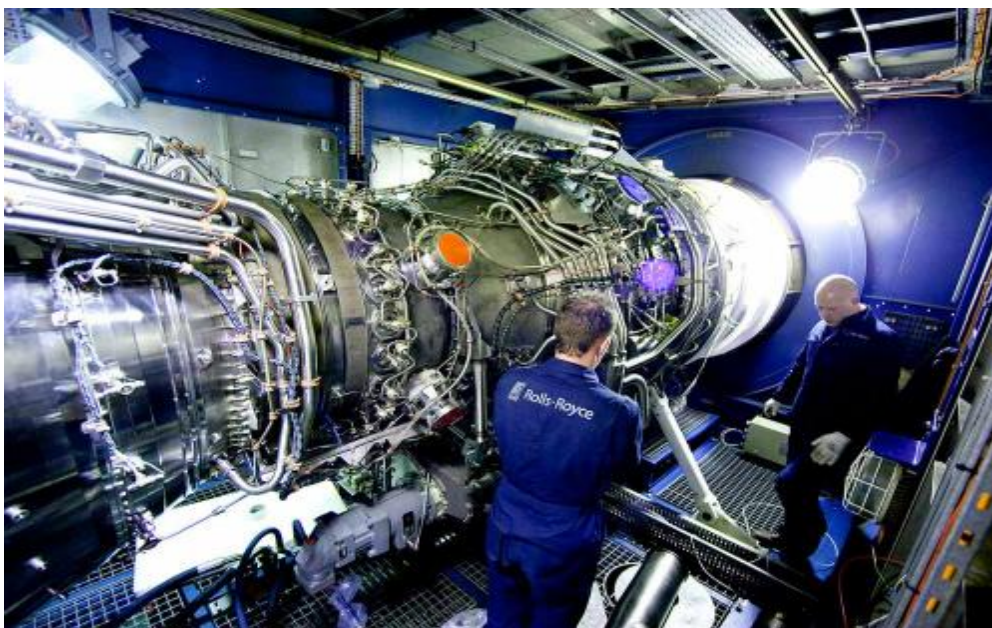
Εικόνα 3: Ο Ναυτικού τύπου MT30 της Rolls-Royce [Πηγή: http://el.marinelink.com/news/rolls-royce ]
