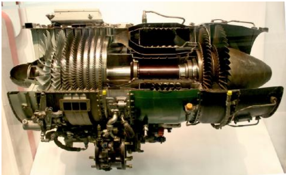
Εικόνα 1: Αεριοστρόβιλο τύπου J85-GE-17A της εταιρίας General Electric (1970). [Πηγή: https://commons.wikimedia.org/wiki/File:J85_ge_17a_turbojet_engine.jpg ]
