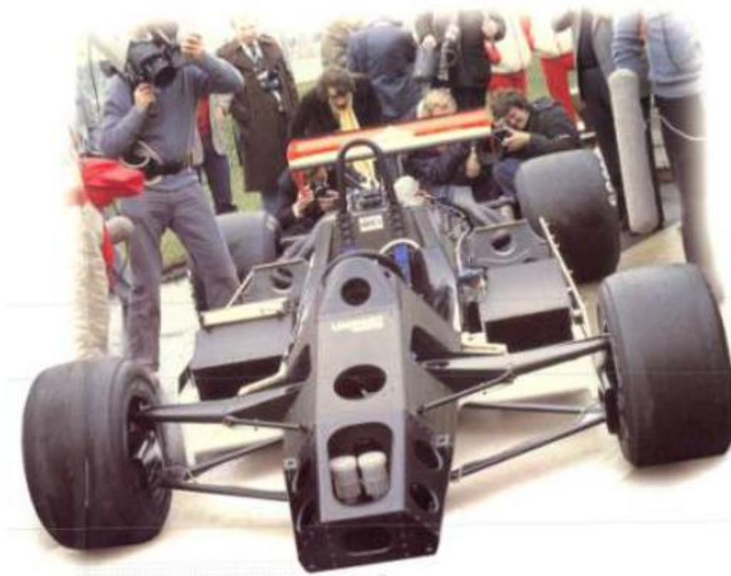
Εικόνα 2.2 : Το πρώτο monopocoque από carbon, McLaren MP4 / 1 (1980). [1]
