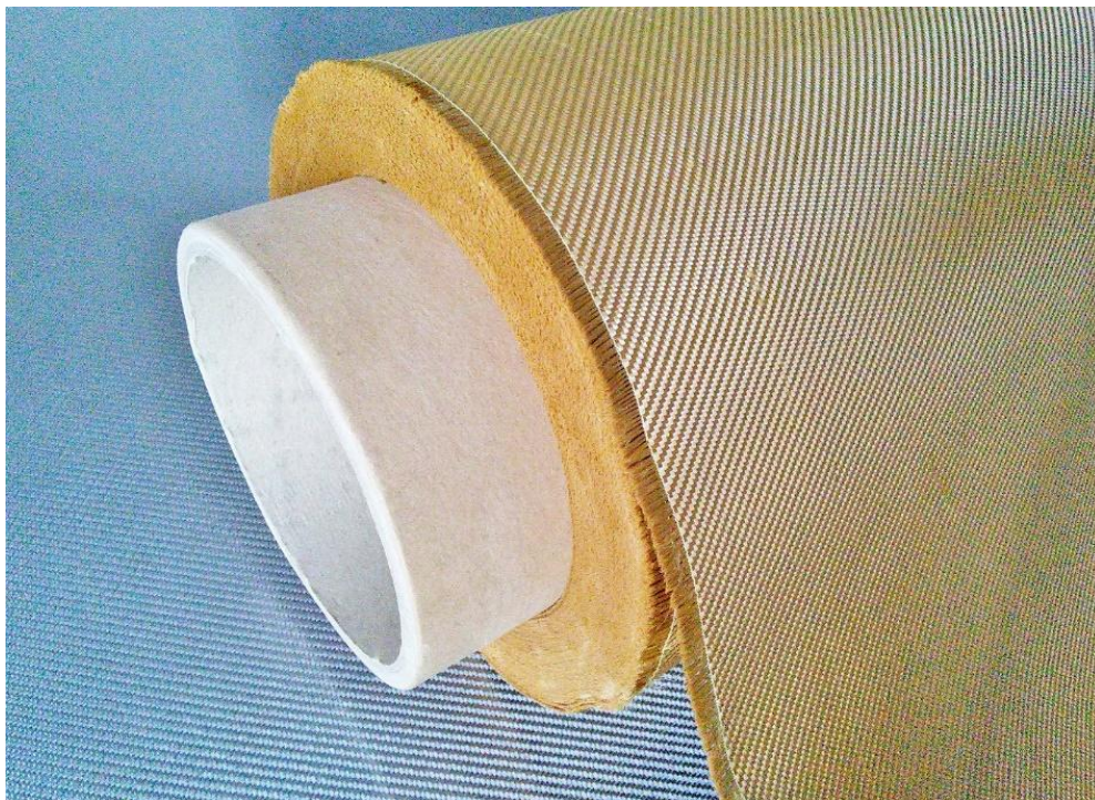
Εικόνα 5.9 : Ύφασμα zylon διαγώνιας πλέξης 2x2. [26]
