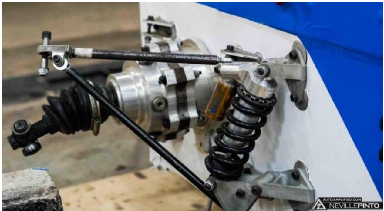
Εικόνα 5.5 : Μέρος ανάρτησης από carbon fiber [22].
