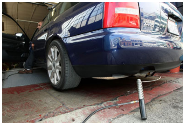
Εικόνα 9 – Τρόπος ανάγνωσης στοιχείων καυσαερίων σε μονάδα ΚΤΕΟ
