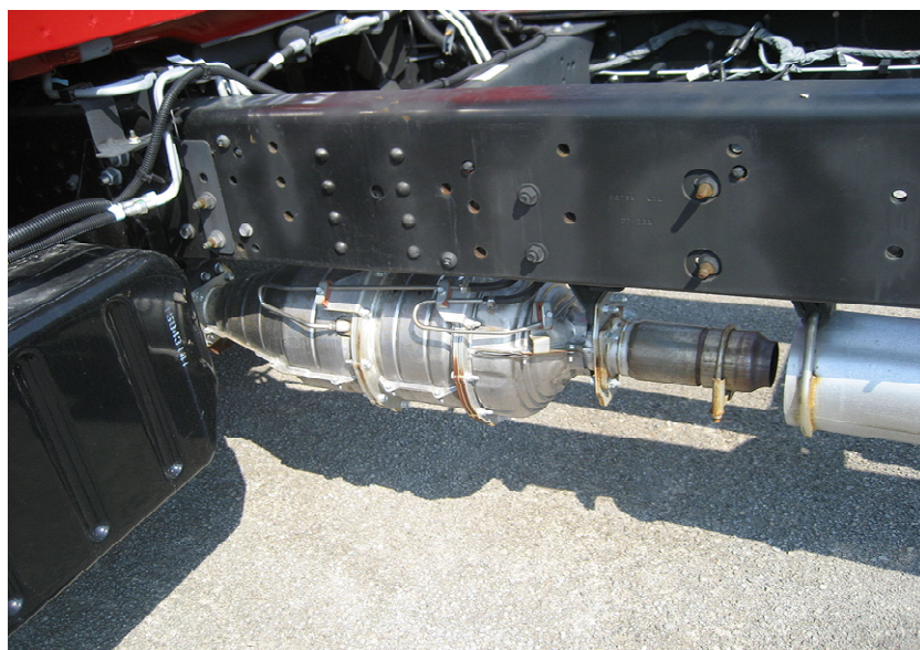
Εικόνα 17: Φίλτρο κατακράτησης σωματιδίων. Φαίνεται ο κυψελοειδής καταλύτης μετά από αυτό.
