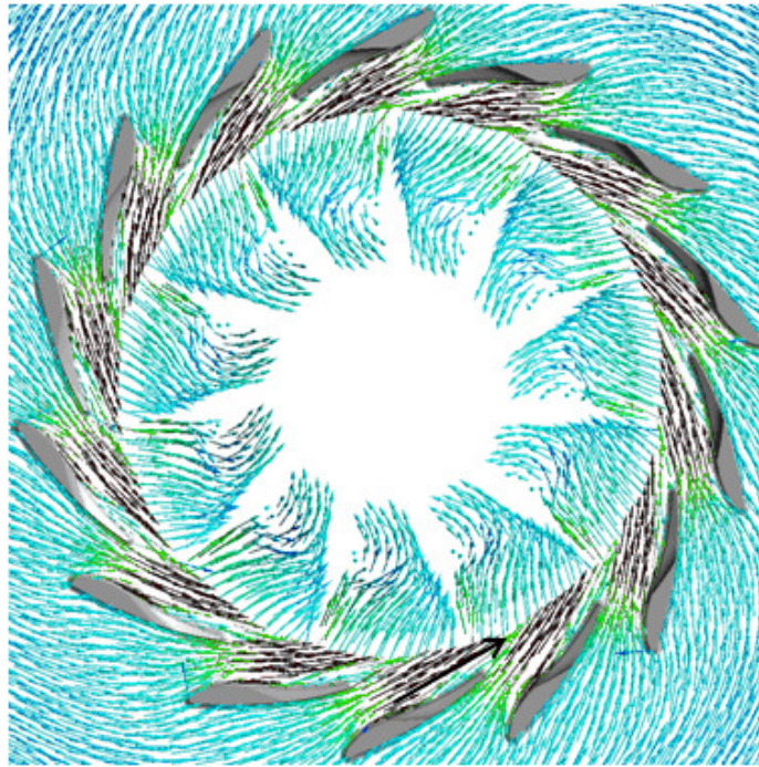
Εικόνα 34: Η σκούρα περιοχή “κάτω” από τα πτερύγια είναι τα συμπιεσμένα καυσαέρια.
