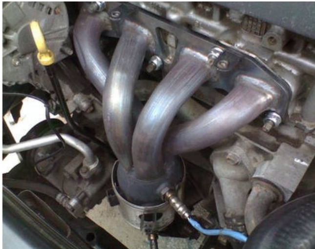
Εικόνα 8 – Καταλυτικός μετατροπέας τοποθετημένος μετά την κυλινδροκεφαλή.
