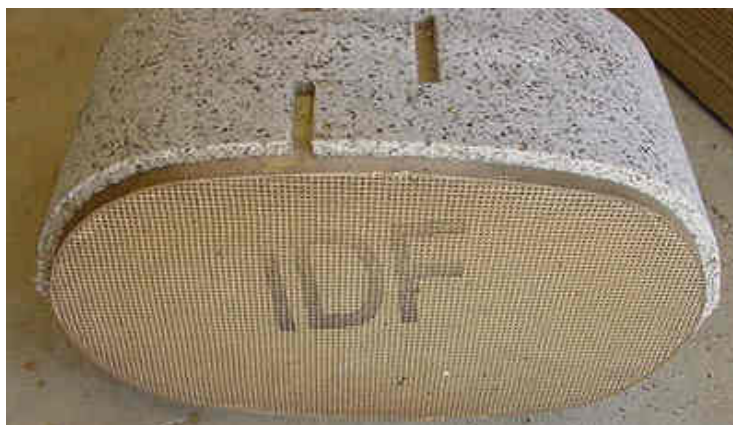
Εικόνα 6 – Κεραμική στρώση καταλύτη και το σύμπλεγμα των υλικών σε μορφή κυψέλης.
