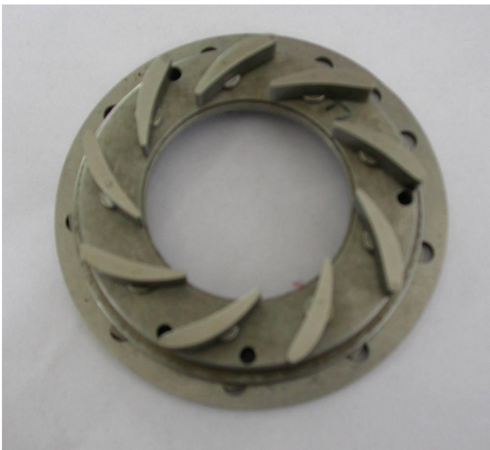
Εικόνα 36: Πλάτη, πτερύγια και δαχτυλίδι λειτουργίας από τουρμπίνα BorgWarner. (Πηγή: http://www.turbos.borgwarner.com/en/products/vtg.aspx )
