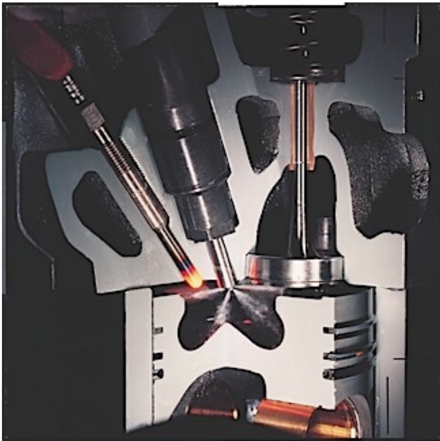
Εικόνα 25: Τομή ενός θαλάμου καύσης πετρελαιοκινητήρα με άμεσο ψεκάσμο. Παρατηρούμε τον ψεκάσμο πολλαπλών σημείων μέσα στην κορόνα του εμβόλου και το σχήμα αυτής. (Πηγή: Bosch Auto Parts)
