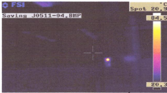
Εικόνα 63: Η μέτρηση θερμοκρασίας αντικειμένου με μέγεθος μικρότερο του ανοίγματος του spot meter δεν είναι ακριβής [6]
