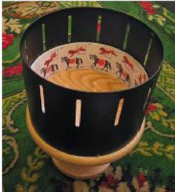
Εικόνα 63 - Zoetrope, συσκευή που παράγει την ψευδαίσθηση της κίνησης Πηγή: https://goo.gl/DRekQA
