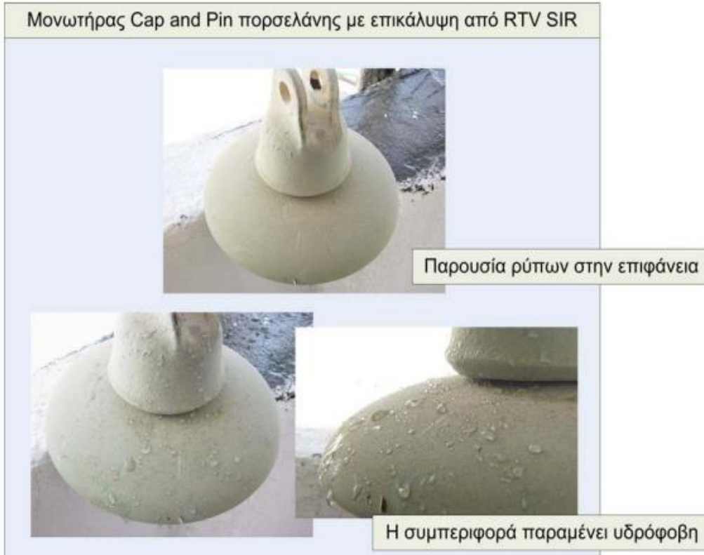
Εικόνα 52: Μονωτήρας πορσελάνης με επικάλυψη από RTV SIR [4]
