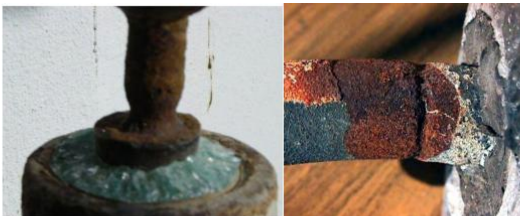
Εικόνα 39: Επιπτώσεις διάβρωσης σε μονωτήρες τύπου cap & pin
