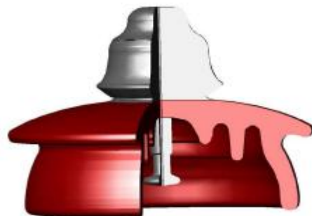
Εικόνα 51: Μονωτήρας με βελτιστοποιημένο σχήμα
