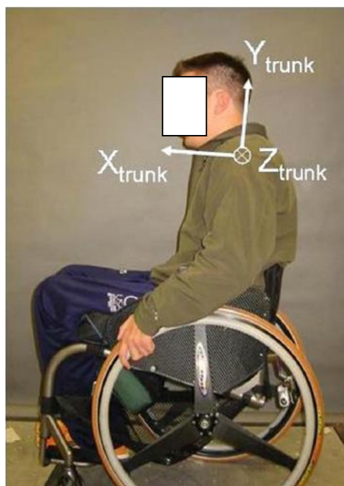
Εικόνα 11. Τοπικό σύστημα συντεταγμένων κορμού (Τροποποιημένο από Mercer et al., 2006)
