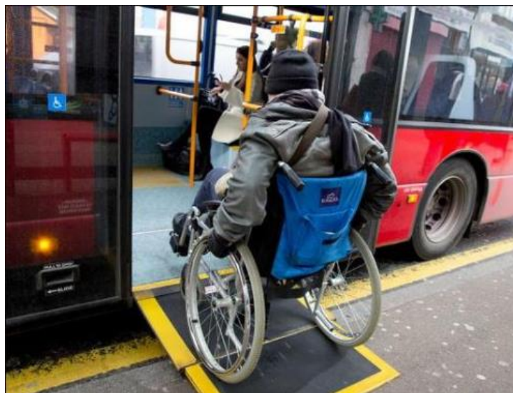
Εικόνα 28. Μηχανισμός επιγονάτισης και ράμπα σε αστικό λεωφορείο (Τροποποιημένο από www.google.de )
