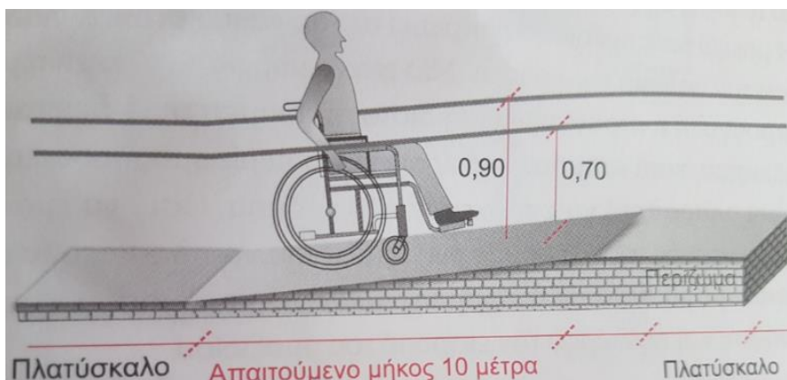
Εικόνα 26. Σχηματική αναπαράσταση χαρακτηριστικών ράμπας (Τροποποιημένο από Μπάκας, 2012).
