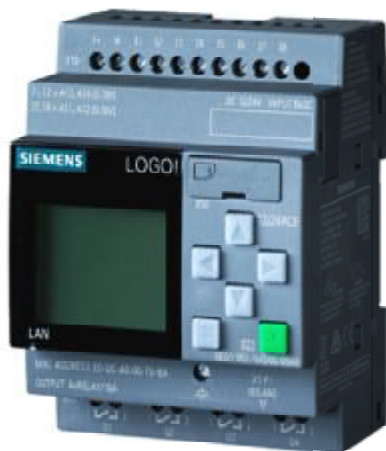
Εικόνα 1.3.3 PLC της εταιρίας Siemens που χρησιμοποιήθηκε στο Skills USA Robotic and Automation Technology (RAT) competition, (Πηγή E6).
