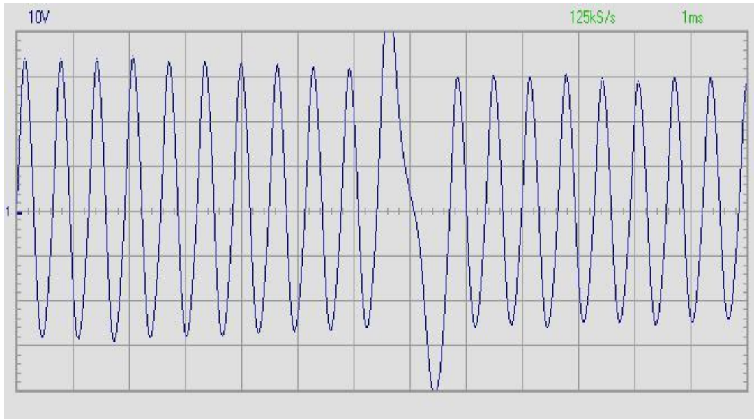
Σχήμα 16: Εναλλασσόμενη τάση επαγωγικού αισθητήρα
