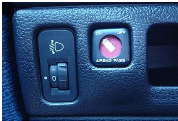
Εικόνα 9: Στα περισσότερα σύγχρονα αυτοκίνητα, όπως σε αυτό το Peugeot 206 του 1999, υπάρχει ένας διακόπτης με τον οποίο ο οδηγός μπορεί να απενεργοποιήσει τον αερόσακο συνοδηγού.
