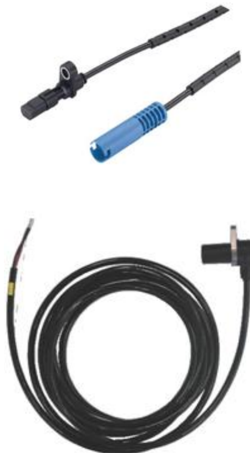
Εικόνα 7: Αισθητήρας επαγωγικού τύπου και ανιχνεύει την ταχύτητα περιστροφής του τροχού
