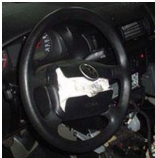
Εικόνα 8: Διπλωμένος αερόσακος οδηγού κάτω από το κάλυμμα του τιμονιού, σε ένα Volkswagen Passat. Το κάλυμμα έχει ανοιχτεί εν μέρει, για να φανεί ο αερόσακος.
