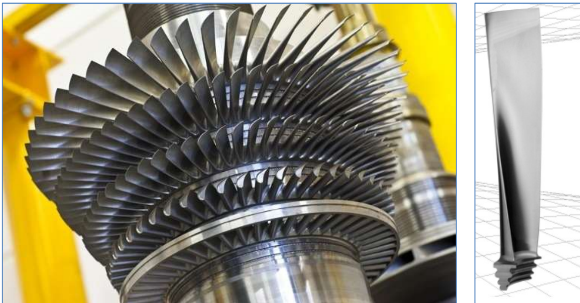
Εικόνα 4-4: Πτερύγια ατμοστροβίλου και λεπτομέρεια
