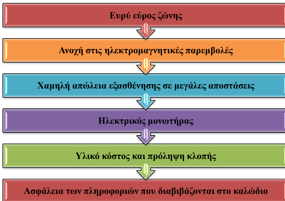
Σχήμα 1.1: πλεονεκτήματα της επικοινωνίας οπτικών ινών σε σχέση με τα συστήματα χάλκινων συρμάτων.
