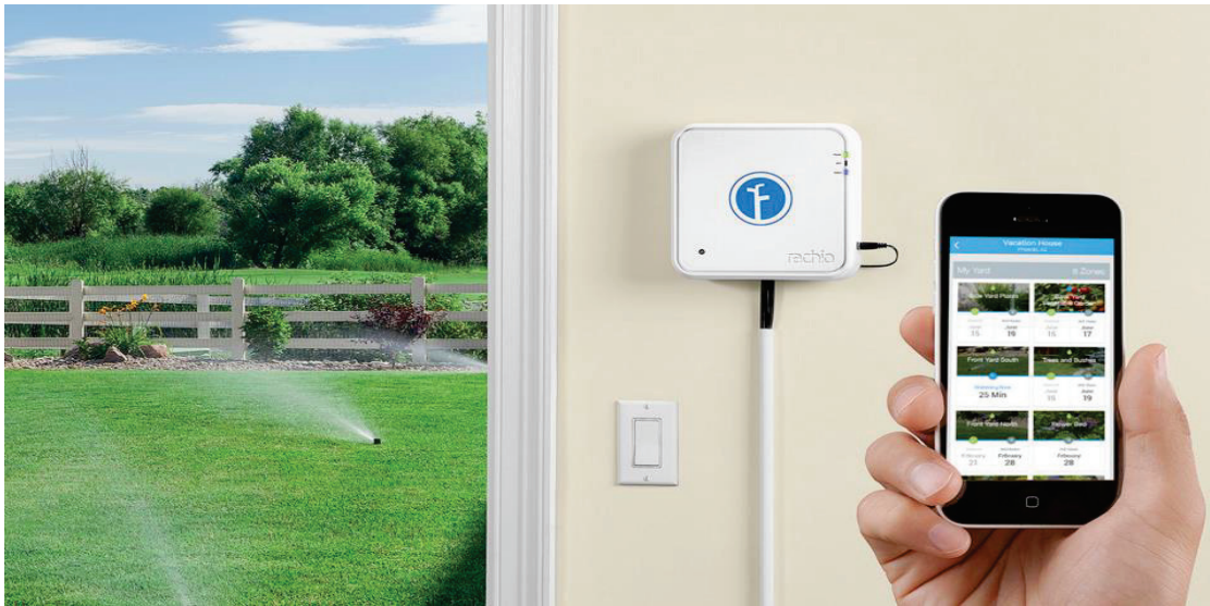
Εικόνα 13 : Απομακρυσμένος χειρισμός αυτόματου ποτίσματος από κινητό τηλέφωνο.
