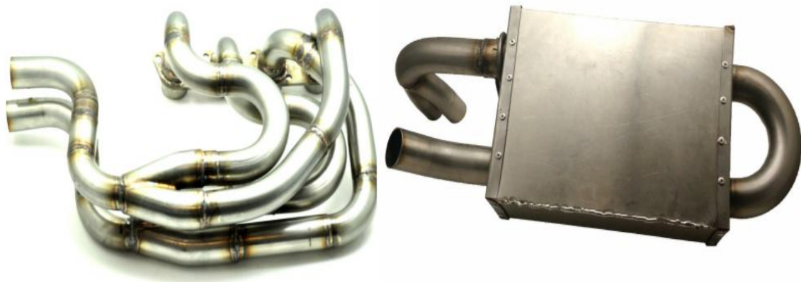
Εικόνα 12: Ολοκληρωμένη η πολλαπλή εξαγωγής 421 (αριστερά) και ο απορροφητικός σιγαστήρας (δεξιά) [7]
