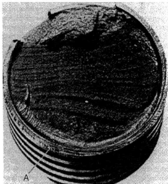
Σχ. 1.2: Επιφάνεια θραύσης λόγω κόπωσης σε σπείρωμα [1]
