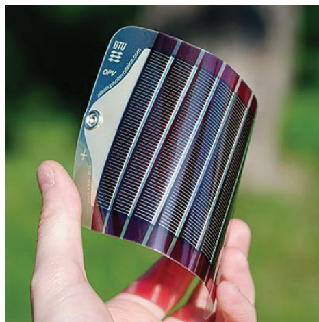
Εικόνα 2.15: Εύκαμπτο οργανικό φωτοβολταϊκό[50]
