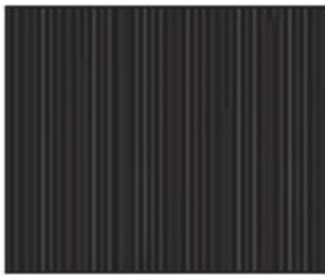
Εικόνα 2.11: Κύτταρο δισεληνοϊνδούχου χαλκού [44]
