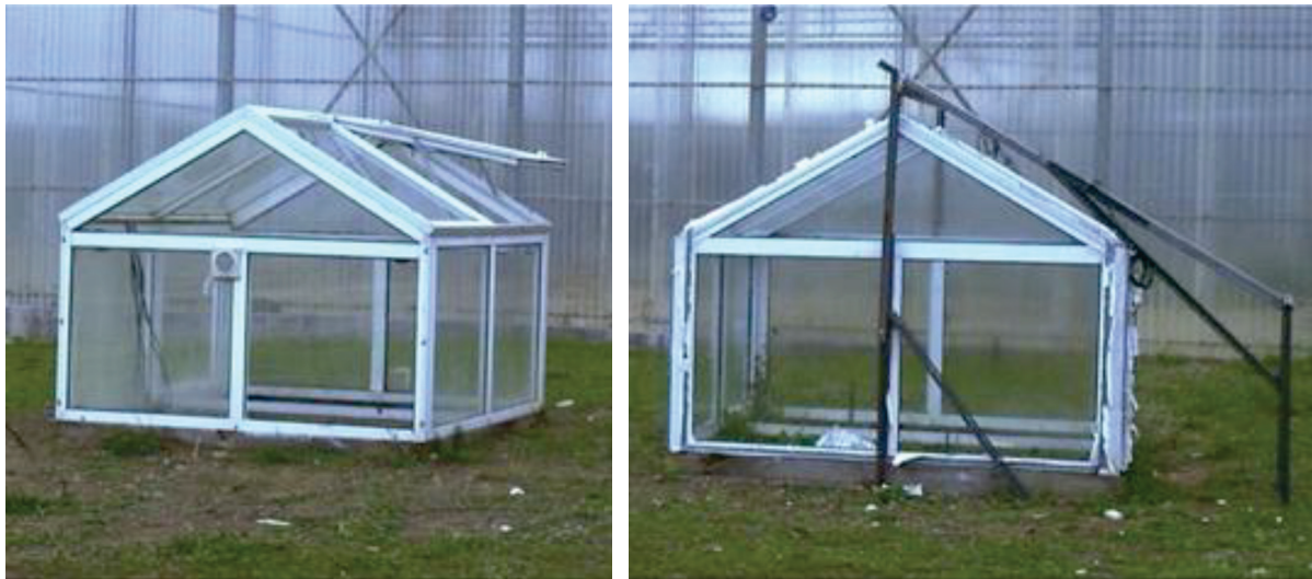
Εικόνα 4.1: Πειραματικά θερμοκήπια. Αριστερά θερμοκήπιο αναφοράς. Δεξιά θερμοκήπιο με φωτοβολταϊκά στην οροφή του[1]
