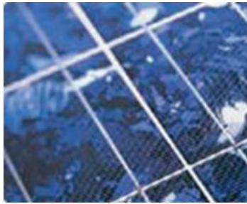
Εικόνα 2.9: Κύτταρο πολυκρυσταλλικού πυριτίου [44]
