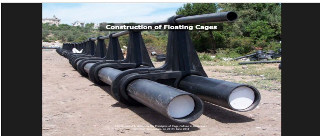
Εικόνα 11. Συνδεσμολογία πλαστικών ιχθυοκλωβών, καθώς επίσης μπορούμε να διακρίνουμε και το γέμισμα των σωλήνων με διογκωμένη πολυστερίνη.
