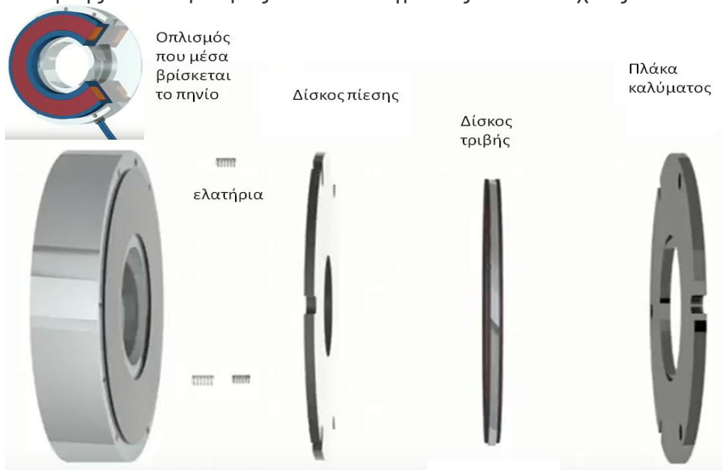
Εικόνα 27: Διάταξη μηχανικής πέδης
