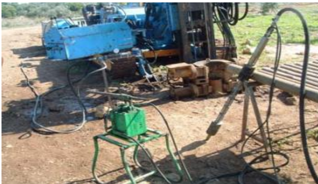
ΣΧΗΜΑ 2.3 Αντλία εισπίεσης νερού για την δοκιμή Lugeon
