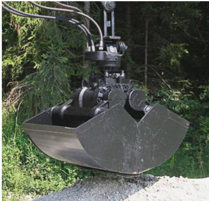
Σχήμα 3.2 Για την εκσκαφή του διαφραγματικού τοίχου απαιτείται η χρήση του εικονιζόμενου εξαρτήματος (αρπάγη)
